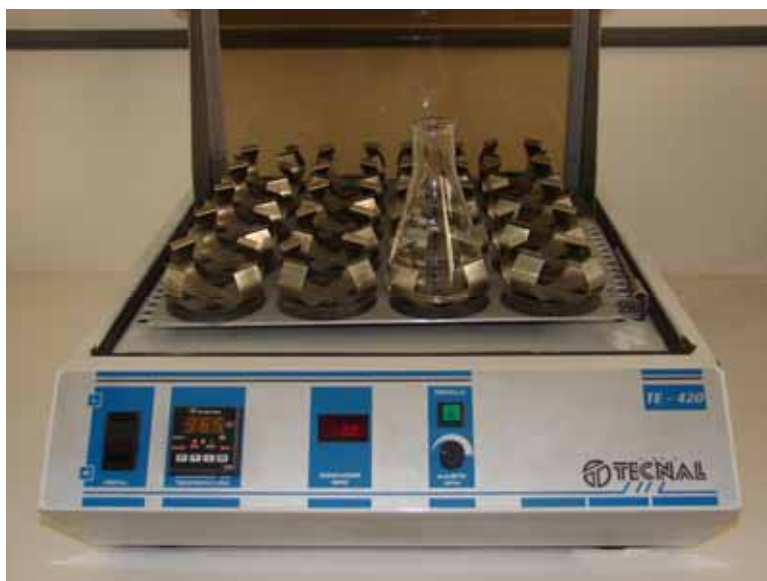
Figura 6. Mesa giratória com os espécimes em EDTA
