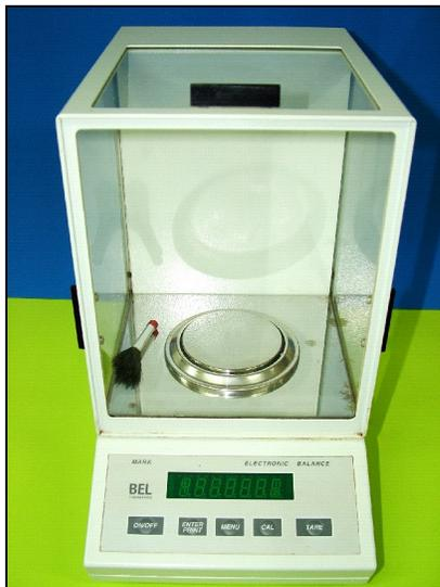
Figura 3 – Balança analítica digital de 0,0001g de precisão.
