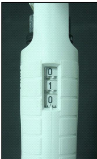
Figura 5 – Micropipeta ajustada em 10 $\mu$ L.
