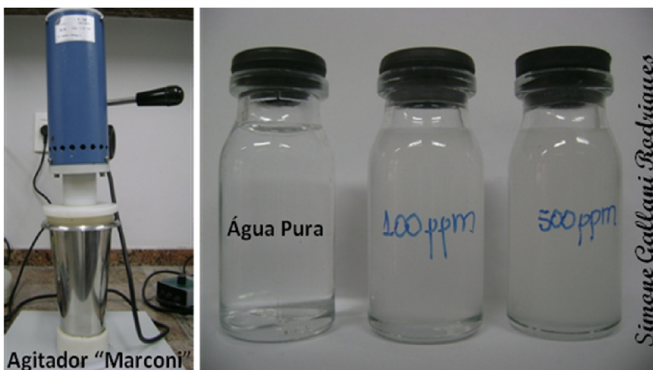
FIGURA 11: Agitador utilizado para preparação das emulsões e ilustração das emulsões de 100ppm e 500ppm, comparando com água pura.
