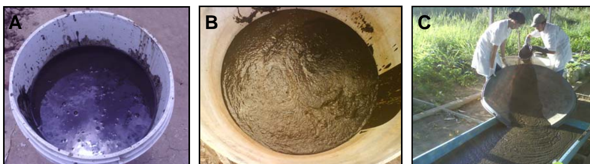
Figura 05 Pré-tratamento do lodo. A – Fotos do lodo transportado de Malhada da Roça; B – Foto da secagem natural do lodo em uma caixa cilíndrica de amianto; C – Foto da secagem do lodo.
