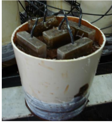
Figura 5 - Coluna de solo com a distribuição das sondas de TDR.
