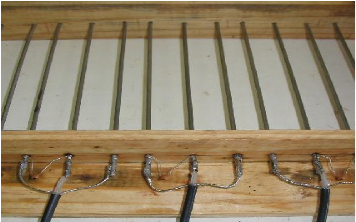
Figura 2 - Estrutura das sondas de TDR.
