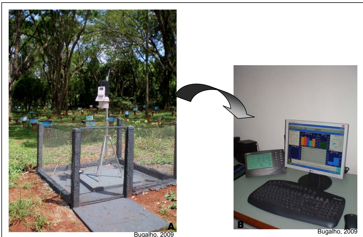
Figura 11: Estação Climatológica, Modelo Vantage Pro 2, instalada no apiário experimental do Departamento de Genética da Faculdade de Medicina de Ribeirão Preto – USP e laboratórios integrados Apilab. A) Parte externa instalada no apiário responsável por captar os dados climáticos. B) Computador responsável pela captação e armazenamentos dos dados coletadas pela estação;.
