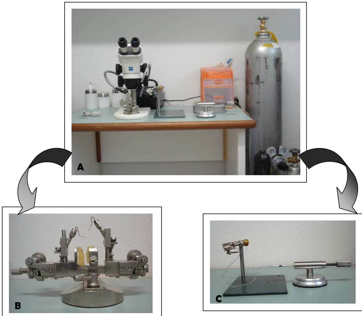
Figura 7: A) Equipamento de inseminação. B) Aparelho de inseminação modelo Gonçalves & Brites (1970). C) mini-seringa modelo Francoy & Gonçalves (2004).
