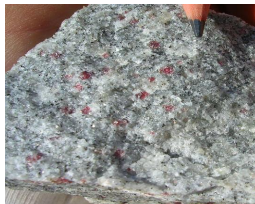
Figura 26. Granada-biotita granito com foliação incipiente da Suíte Ataléia (NV02; 351936/ 7936746).
