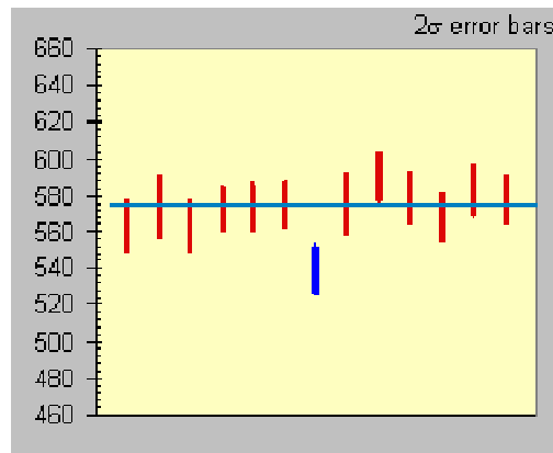
Figura 98. Diagrama de idade calculada a partir da média ^{238}\text{U}/^{206}\text{Pb} para doze spots coerentes, resultando no valor de 574,7 \pm 3,9 (95% conf.; MSWD = 1,35; probabilidade = 0,19).
