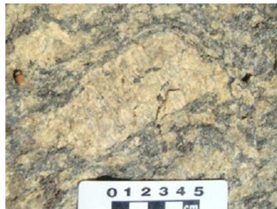
Figura 51. Granada-biotita granito da Suíte Montanha com porfiroclasto de feldspato potássico rotacionado (MF1; 355109/7995707).
