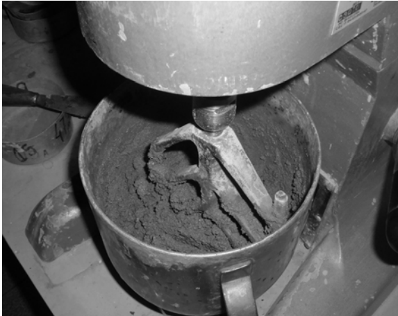
Figura 21. a) Argamassa sem adição de polímero (referência) b) Argamassa com polímero (MC5h).
