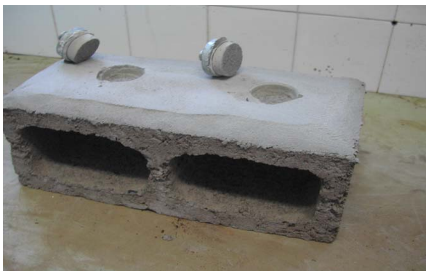
Figura 23. Argamassa, com MC5h, antes e após teste de arrancamento.
