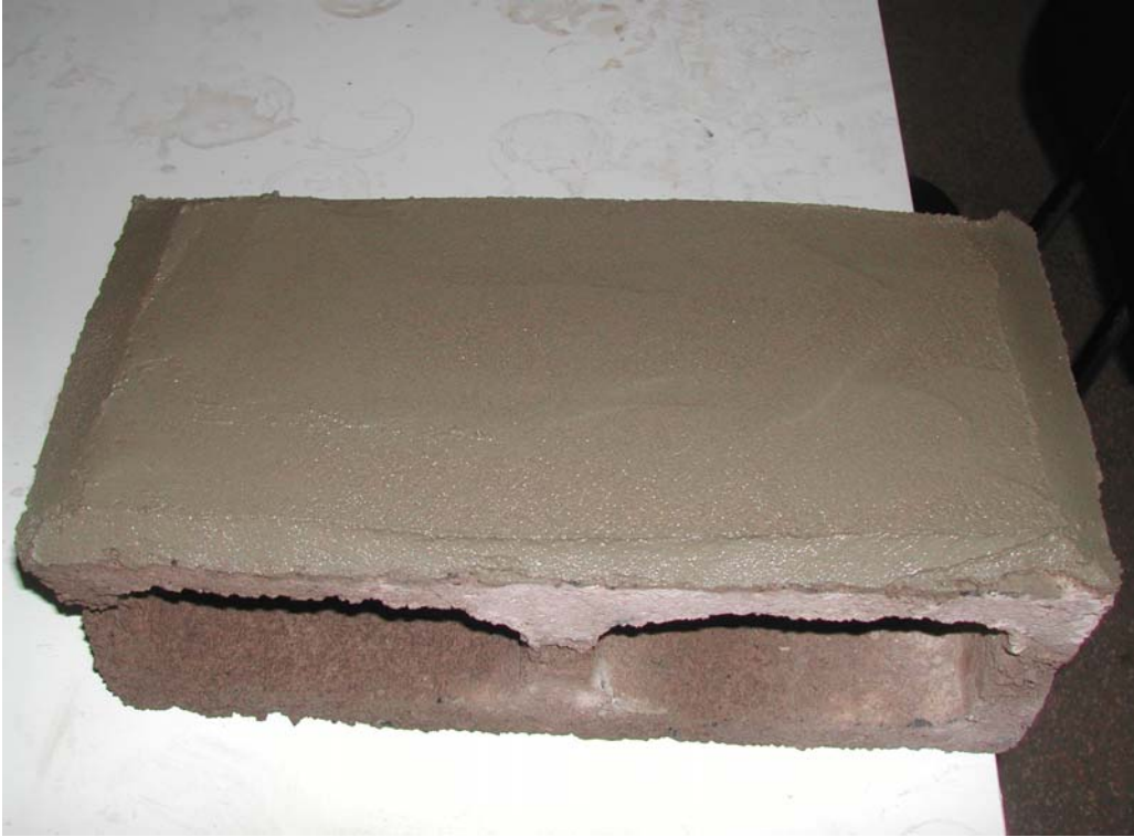
Figura 22. Trabalhabilidade da argamassa empregada no teste de aderência.
