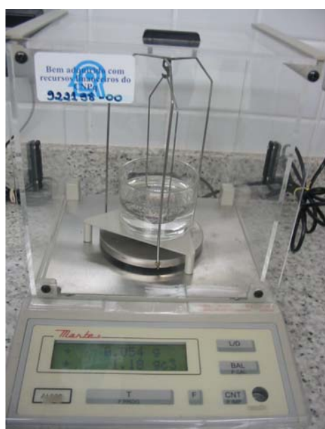
Figura 5: Balança de pesagem hidrostática para aferição da densidade do fêmur.
