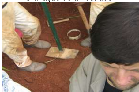
Término da cravação do amostrador.
