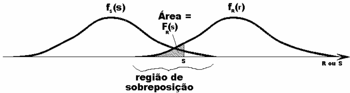
FIGURA 3.2 – FUNÇÃO DENSIDADE DE PROBABILIDADE f_R(r) e f_S(s) (Ang e Tang, 1990)
