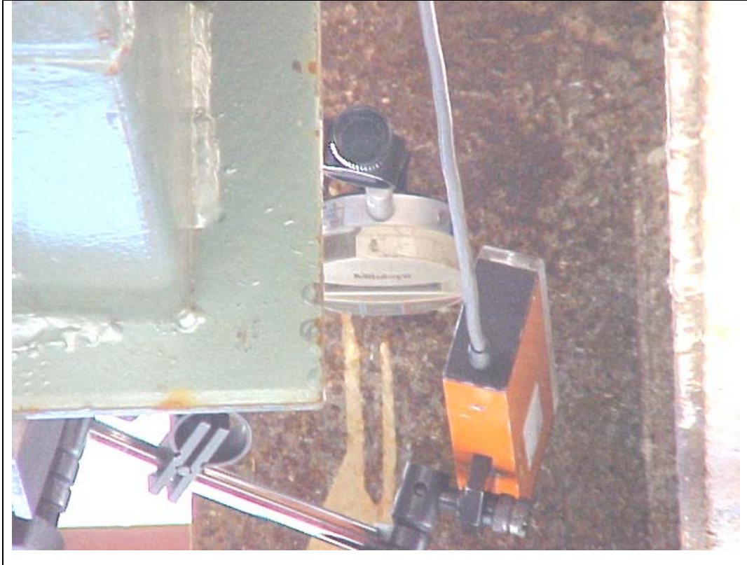
FIGURA 5.2.2 Foto sobre-cabeça do relógio comparador ao lado de um DT, ambos, debaixo da placa superior do pilar.
