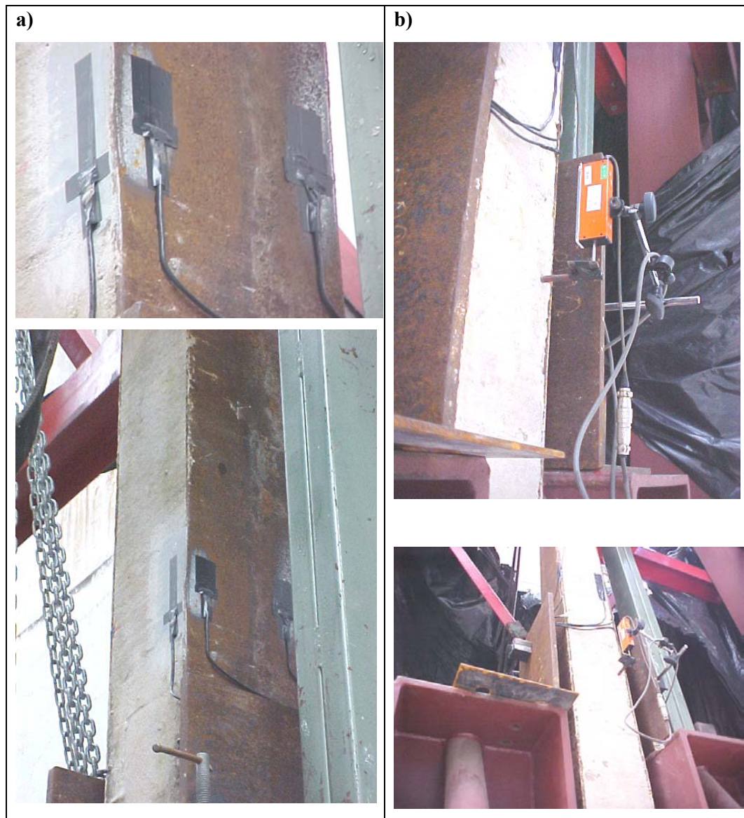
FIGURA 5.2.1 a) “ Strain-gages” no aço e no concreto; b) DT's para escorregamentos.
