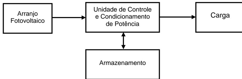
Figura 3.1 – Configuração Básica de Sistemas Fotovoltaicos
