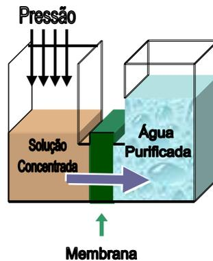
Figura 2.2 – Representação do Processo de Osmose Inversa
