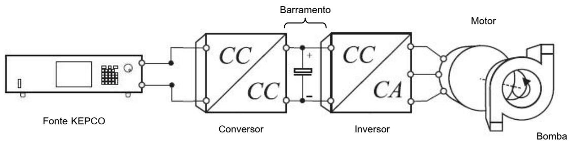
Figura 4.3 – Topologia do Sistema de Acionamento
