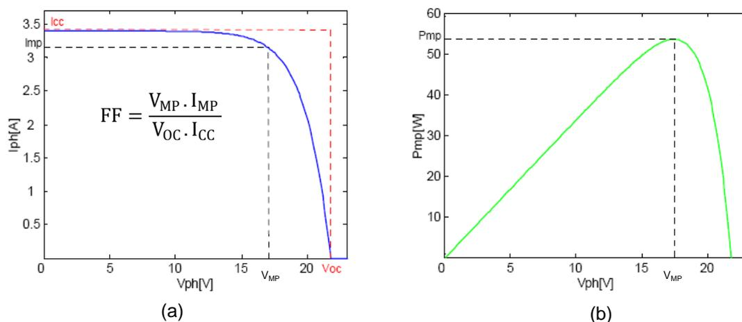
Figura 3.7 – Curva Característica  $I \times V$ , com Definição do FF, e a Curva de Potência do Módulo
