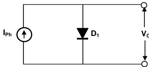
Figura 3.4 – Circuito Equivalente da Célula Solar (Modelo Ideal)
