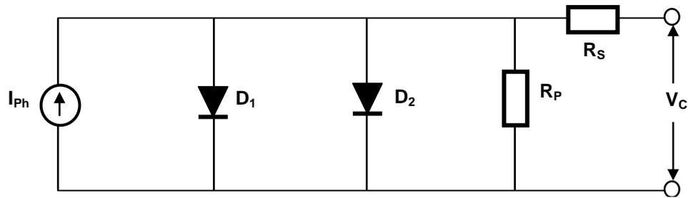
Figura 3.5 – Circuito Equivalente da Célula Solar (Modelo Real)
