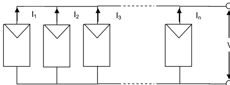
Figura 3.9 – Arranjo Paralelo dos Módulos
