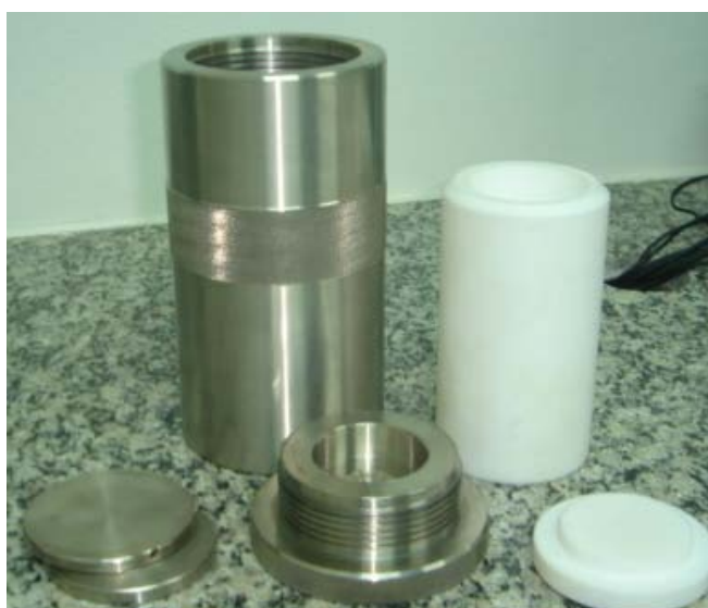
Figura 16. Sistema utilizado na síntese da zeólita.
