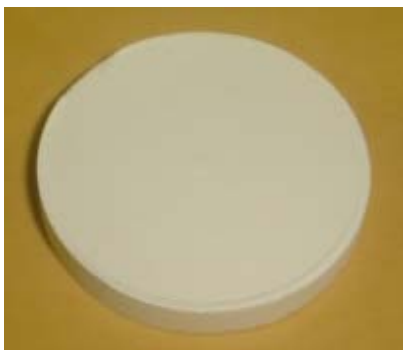
Figura 18. Suporte cerâmico sinterizado a 1400°C.
