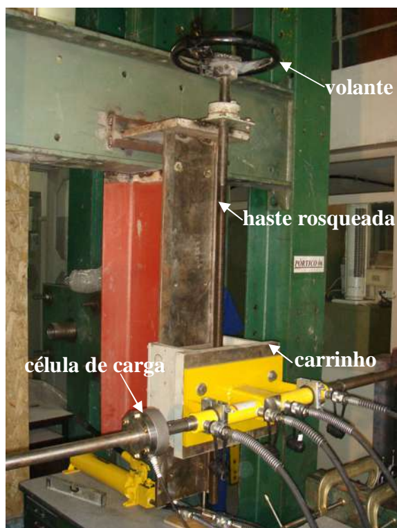
FIGURA 3.12 Sistema de aplicação de carga
