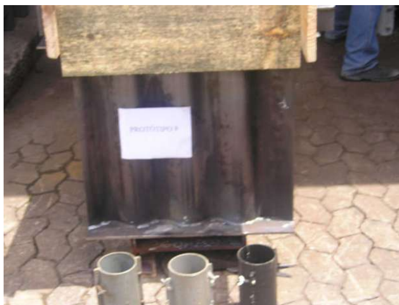
FIGURA 3.7 CPs moldados do concreto de cada protótipo para ensaio de compressão
