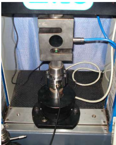
FIGURA 3.18 Calibração da célula de carga
