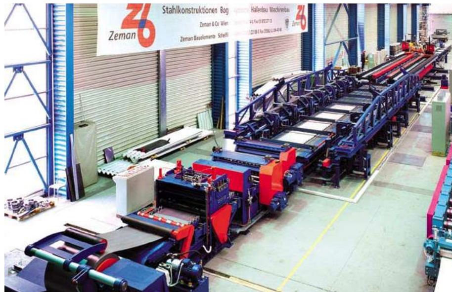
FIGURA 1.9 Esquema de fabricação dos perfis de alma senoidal. Fonte: SIOKOLA (1997)
