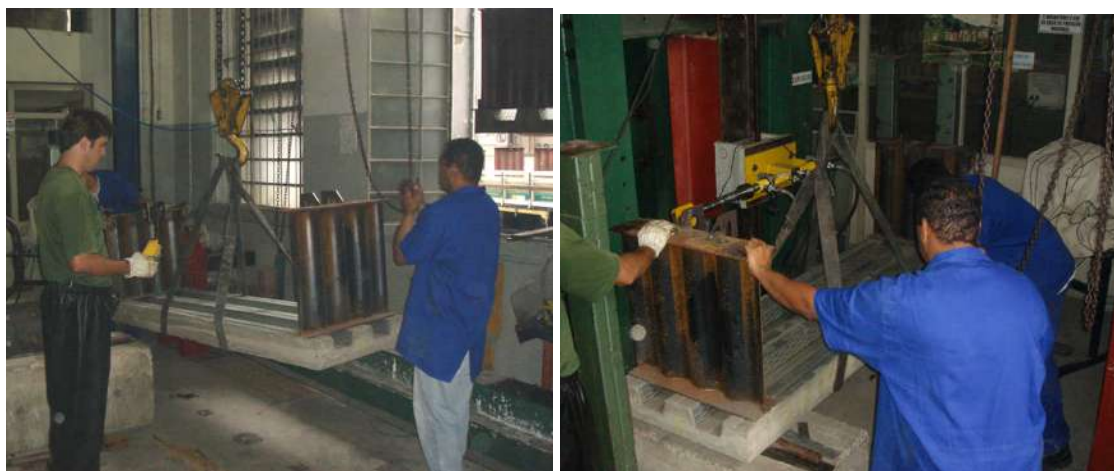
FIGURA 3.9 Colocação dos protótipos na posição de ensaio
