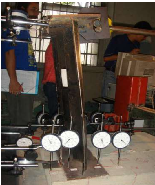
FIGURA 3.27 Deformação da viga U2A-P no final do ensaio com plastificação local na alma
