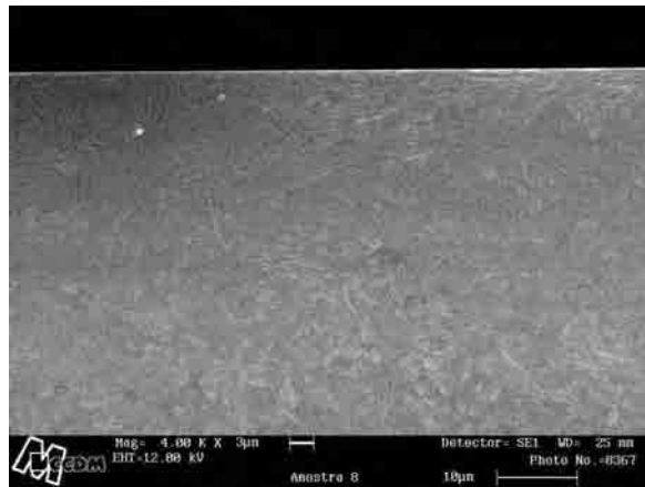
Figura 6.40 - MEV para Rebolo de Óxido, MQL com velocidade do ar = 30 m/s e vazão do lubrificante = 60 ml/h
