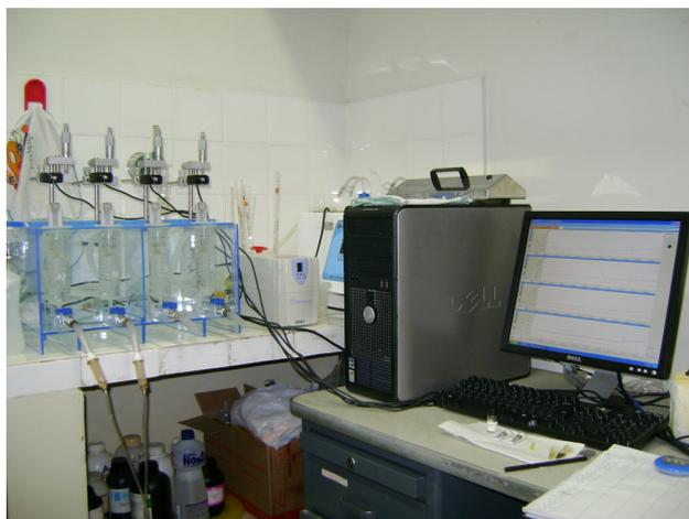
Figura 5. Aparato utilizado para registros de tensões isométricas.
