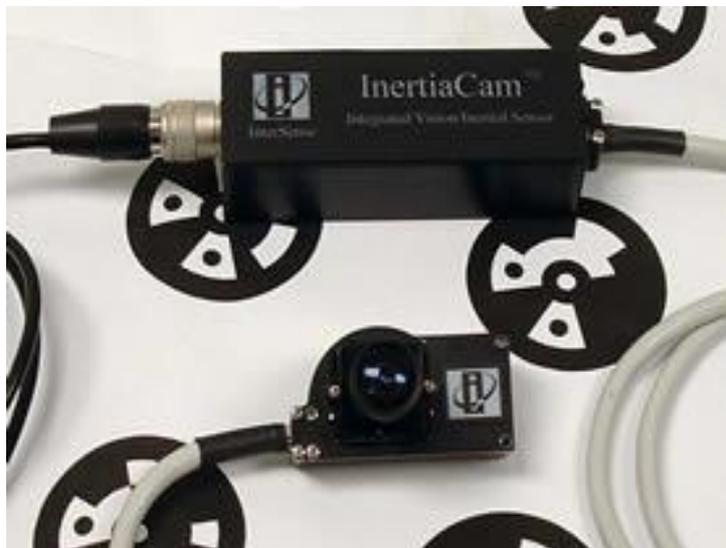
Figura 39 – IS-1200 VisTracker - InertiaCam e marcador Fiducial.
