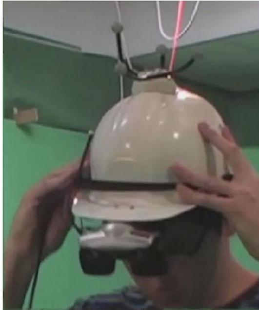
Figura 16 - HMD e rastreador infravermelho.
