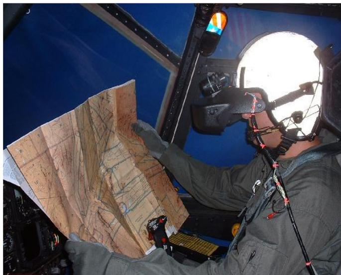
Figura 13 - Piloto usando *HMD* dentro de cabina do helicóptero.
