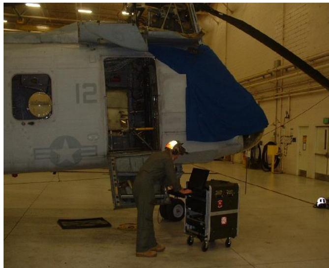
Figura 12 - *ChrAVE* na cabina do piloto com tela azul cobrindo as janelas.
