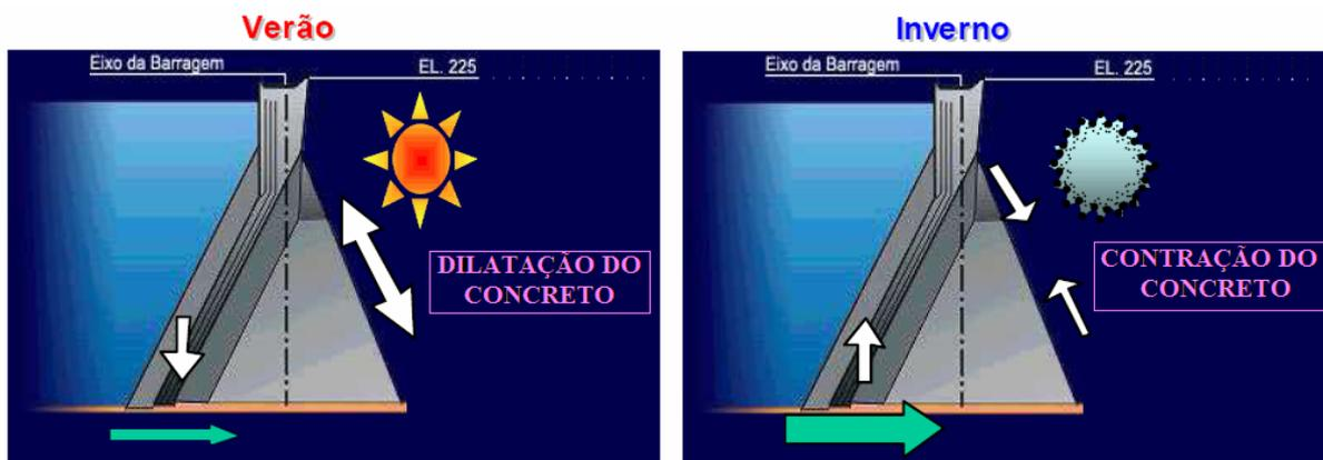
Figura 2.2 – Comportamento da barragem com relação às condições climáticas características de verão e inverno (Adaptada de Osako, 2002).
