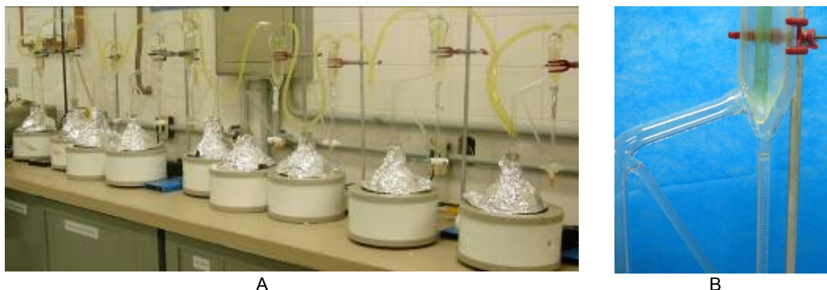
FIGURA 13- EXTRAÇÃO DO ÓLEO ESSENCIAL POR HIDRODESTILAÇÃO EM APARELHO CLEVENGER, DFF, UFPR, CURITIBA, PR, MAIO/JUL., 2008.
