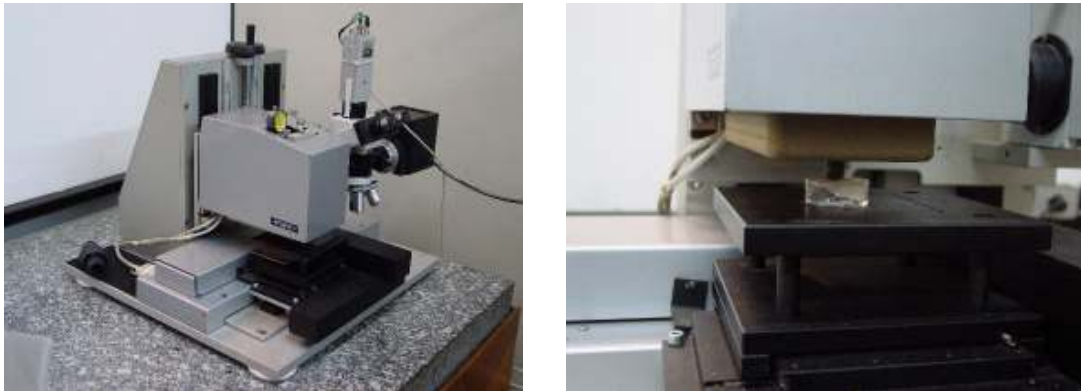
FIGURA 5a e 5b: Equipamento FISCHERSCOPE para os ensaios instrumentados de dureza
