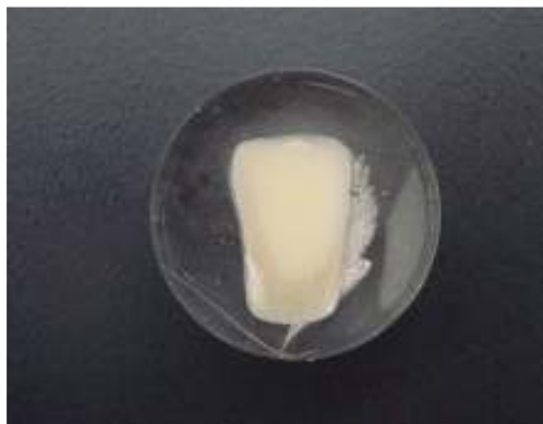
FIGURA 2a: Amostra no embutimento acrílico com superfície vestibular exposta e polida
