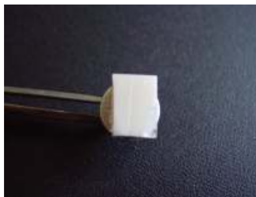
FIGURA 7b: Amostra colada no Stub
