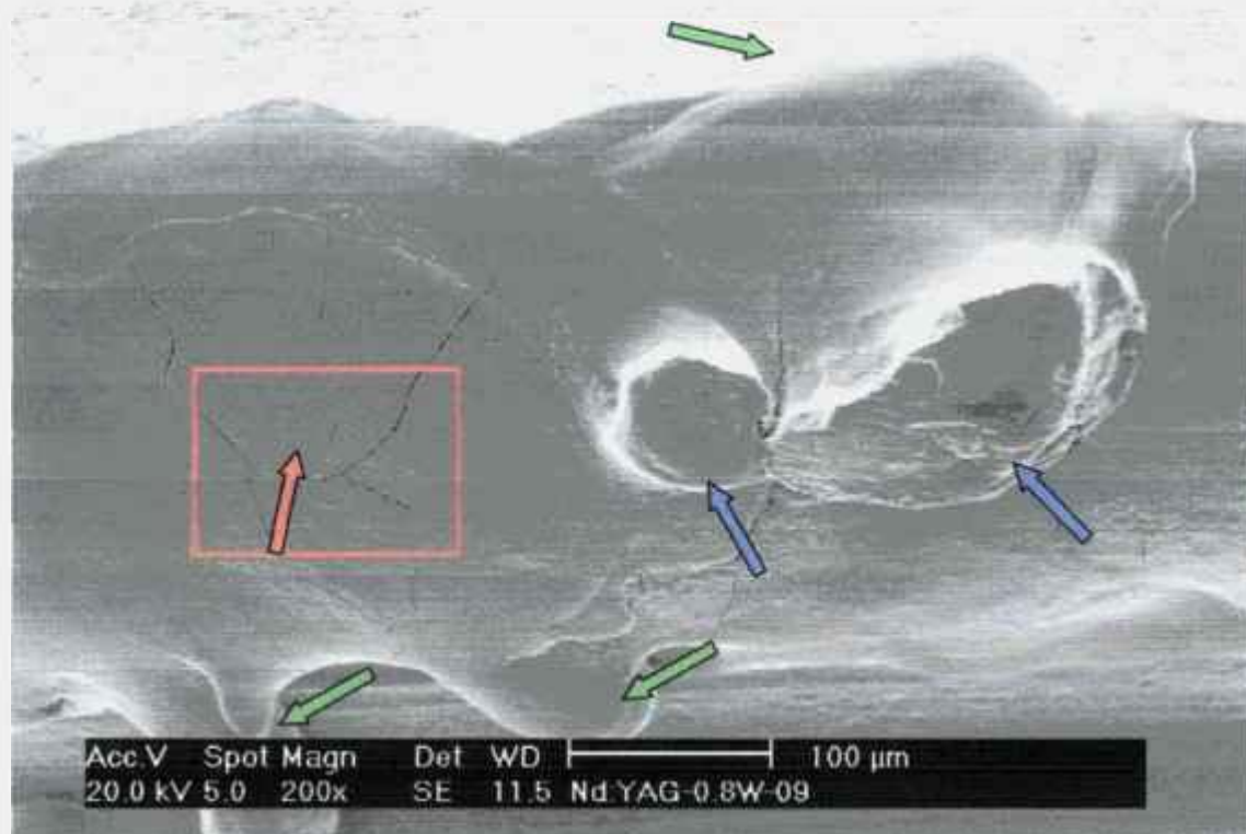
Figura 35 – Micrografia eletrônica de um implante em maior aumento da região demarcada em vermelho na FIG. 34 localiza a área irradiada com laser de Nd:YAG a 0,8W (amostra G2ar09). A área irradiada apresentou alteração morfológica tipo fusão localizada com setas em vermelho, fratura de material localizada com setas azul e fusão seguido de solidificação localizada com setas em verde.
