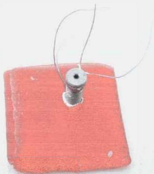
Ilustração 1 – Amostra de Implante oral preparada para receber irradiação laser presa a será 7 e com os dois termopares. Um preso à região cervical e outro preso à região apical. Em ambos os pontos foram aplicados uma gota de pasta térmica para melhorar a precisão da leitura pelo termopar.
