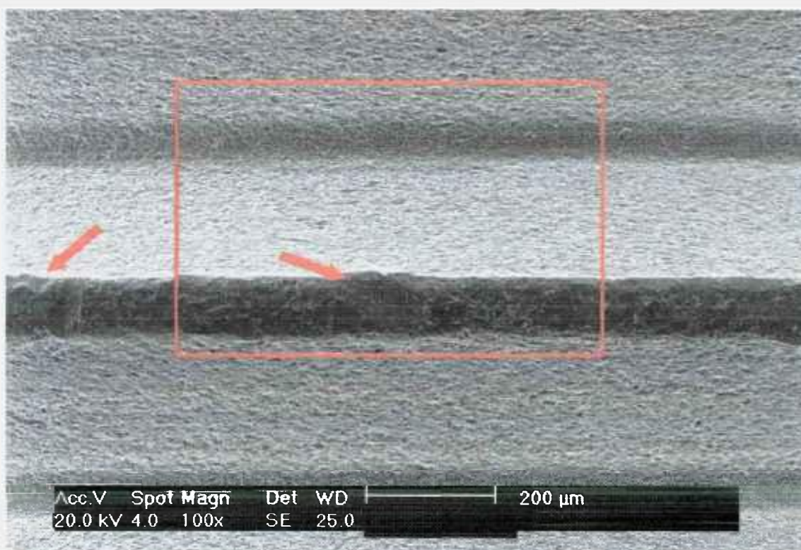
Figura 24 – Micrografia eletrônica de um implante em maior aumento da região demarcada na FIG. 23 região controle apresenta área de uma espira do implante, com pequenas imperfeições estruturais, provocadas pelo torno na confecção do implante (setas em vermelho), estas nada têm a ver com a irradiação das amostras.
