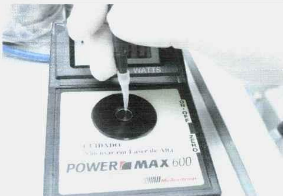
Ilustração 2 – O Power Meter foi utilizado antes e após a cada procedimento de irradiação em cada amostra. Esta calibração foi extremamente necessária para tentar manter uma melhor padronização em termos de irradiação entre as amostras.
