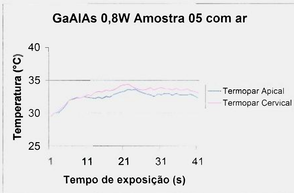
Figura 13 – Monitoramento térmico simultâneo à irradiação com laser de GaAIAs a 0.8W de potência, na superfície de implante oral com arrefecimento constante (amostra 05). Tempo de irradiação total 40s (eixo X em segundos). Temperatura em graus Celsius (eixo Y). O termopar em região cervical e em região apical está diferenciado pela cor.
