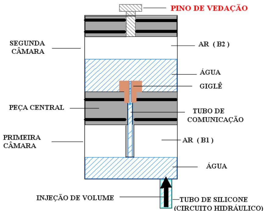
**Figura IV.15: Célula Viscoelástica configurada para o Modelo de Voigt-Maxwell. O pino de vedação em posição na tampa superior permite que a Célula apresente duas câmaras com volumes de ar dimensionáveis de acordo com o preenchimento de água.**
