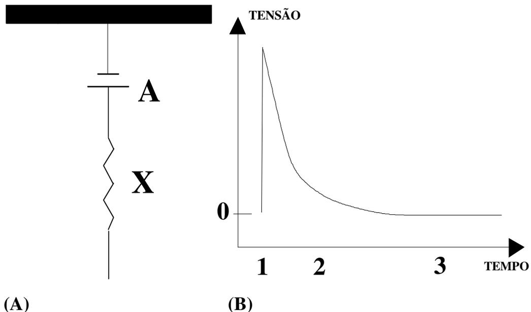
**Figura III.9: (A) Modelo Mola-Amortecedor de Maxwell contendo uma mola X posicionada em série com o amortecedor A (conectados a uma superfície fixa). (B): Curva da tensão em função do tempo, deste modelo quando submetido a um estiramento mantido na mola X. (McDONALD, 1974).**
