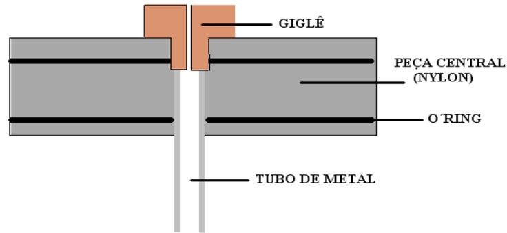
**Figura IV.3: Desenho esquemático da peça central de nylon em que um tubo de metal (inferiormente) e o giglê (superiormente) encontram-se adaptados ao furo de comunicação.**
