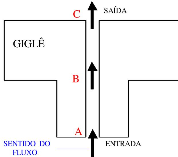
**Figura III.23: Figura esquemática do giglê e os locais onde encontram-se as perdas de carga: na entrada (A), ao longo do comprimento (B) e na saída (C).**
