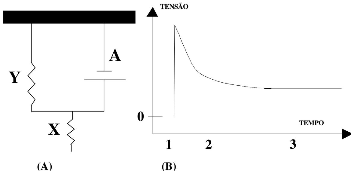
**Figura III.8 (A): Modelo Mola-Amortecedor de Voigt-Maxwell contendo uma mola Y posicionada em paralelo com o amortecedor A (conectados a uma superfície fixa) e ambos em série com a mola X. (B): Curva da tensão (em função do tempo), do modelo quando submetido a uma deformação instantânea na mola X. Os instantes 1, 2 e 3 representam a ordem que cada um dos 3 componentes atuam (McDONALD, 1974).**
