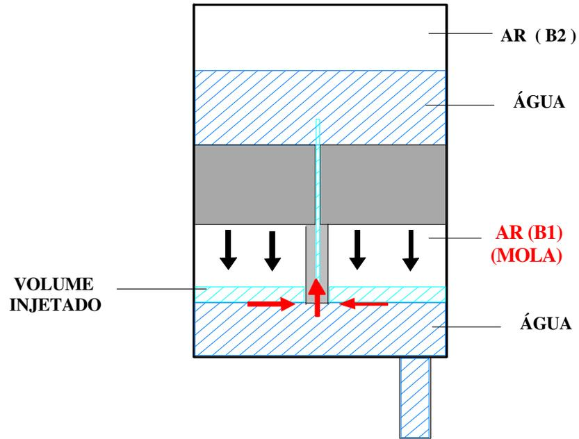
**Figura III.14:** O volume de ar B1 reduzido tem efeito de uma mola e empurra o líquido introduzido (de cor azul clara) para o segundo compartimento (setas em cor preta). A seta em cor vermelha indica que o líquido passa, obrigatoriamente, para o segundo compartimento.
