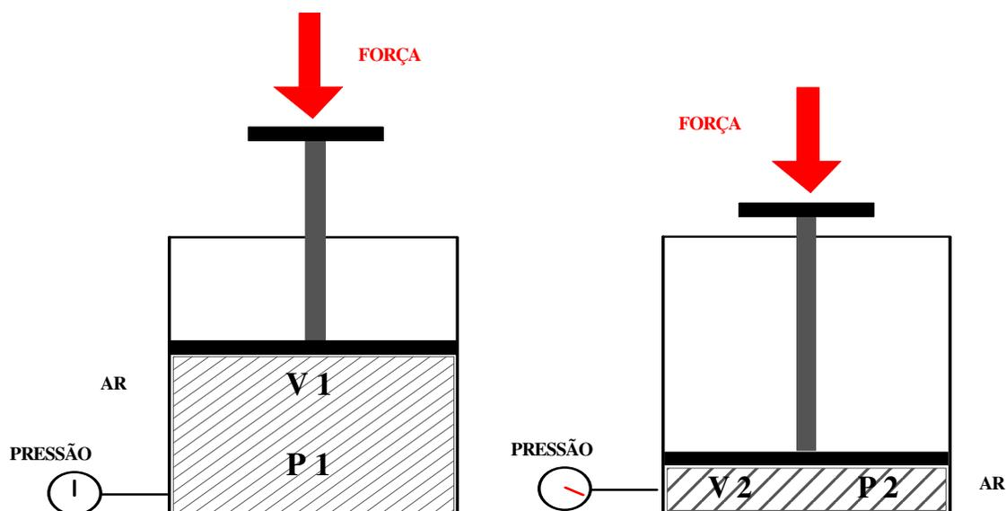
**Figura III.6: Transformação Isotérmica: Recipiente com um volume de ar com pressão inicial “ $P_1$ ” e volume “ $V_1$ ” e um medidor de pressão é conectado ao compartimento. Após este volume de gás ( $V_1$ ) ser comprimido, a pressão ( $P_1$ ) no interior deste eleva-se, como se observa pelo medidor de pressão. A partir de então, tem-se um volume final “ $V_2$ ” e pressão final “ $P_2$ ”.**
