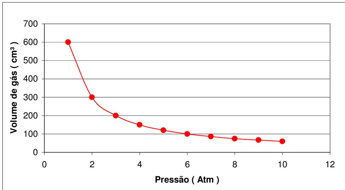
**Figura III.7: Exemplo de uma transformação gasosa segundo a Lei de Boyle. Curva Pressão x Volume onde o produto  $P.V$ , neste caso, será  $600$  ( $\text{cm}^3 \text{ atm}$ ). À medida que a pressão aumenta, o volume do gás diminui.**
