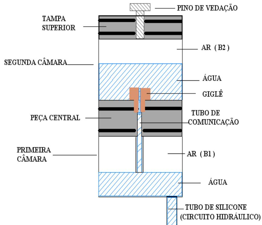
**Figura IV.4: Esquema ilustrativo da Célula Viscoelástica: Câmaras inferior e superior contendo determinado volume de água e de ar (B1 e B2 respectivamente) interligadas por meio de tubo de comunicação.**
