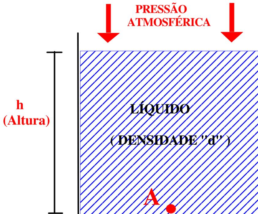
**Figura III.4:** Recipiente aberto contendo água, em contato com a atmosfera. A pressão no “Ponto A” (dentro do recipiente) é igual à soma da pressão exercida pela coluna de líquido de altura  $h$  com a pressão que a atmosfera exerce na superfície do líquido.
