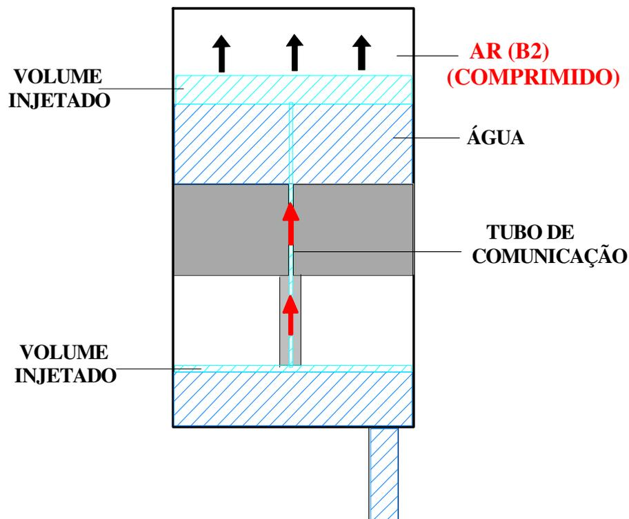
**Figura III.16: Volume de líquido (cor azul clara) passa da primeira para a segunda câmara, via tubo de comunicação (indicado em setas vermelhas). B2 torna-se comprimido pelo volume de líquido, acarretando aí uma elevação da pressão.**
