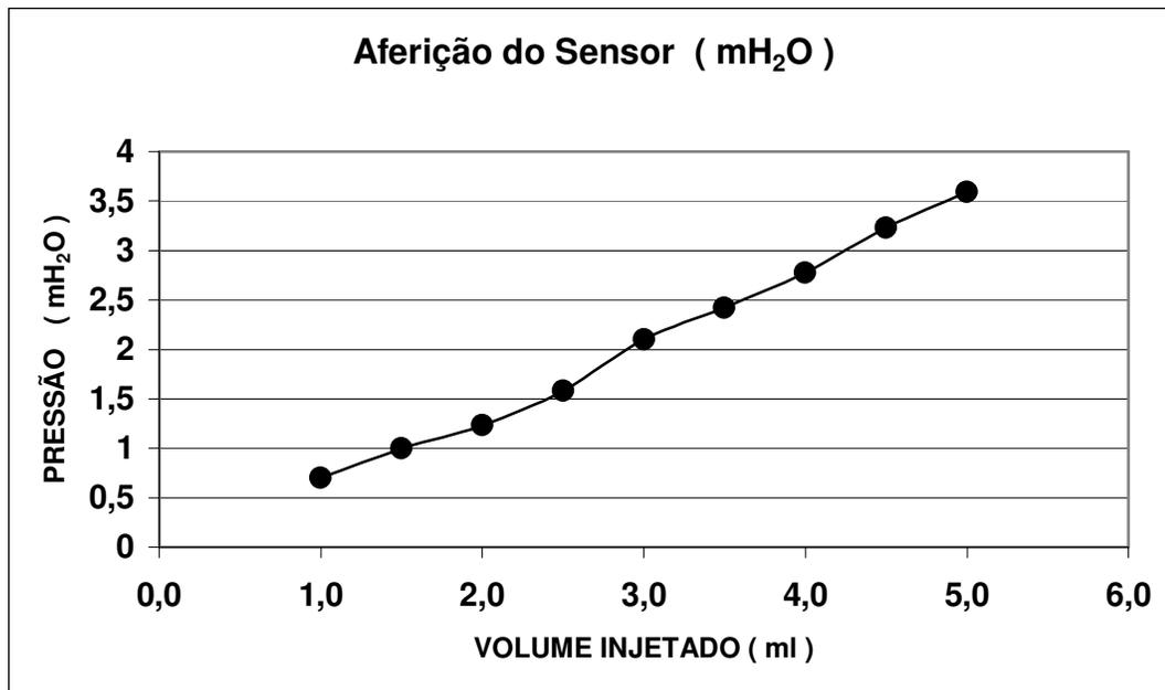
**Figura IV.24:** Curva de Volume Injetado x Pressão, em mH<sub>2</sub>O, obtida confrontando-se os dados das diferentes calibrações.
