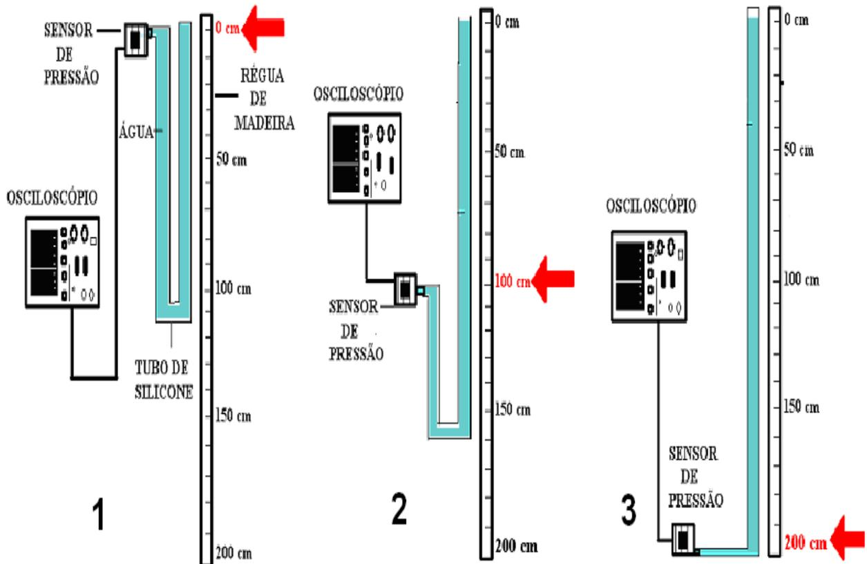
**Figura IV.18:** Figura esquemática da aferição do sensor pela coluna de água. Posicionou-se o tubo preenchido com água ao lado de uma régua de madeira e conectou-se o sensor em sua extremidade inferior.
