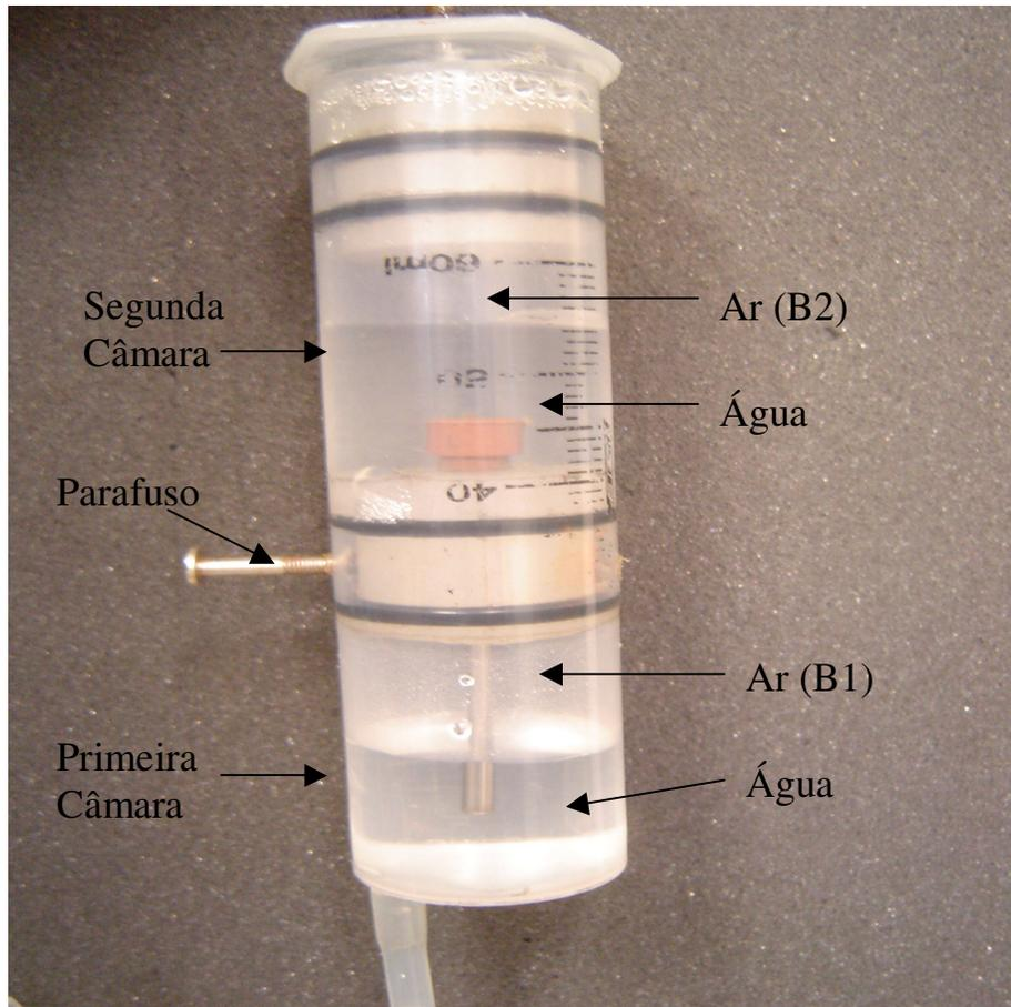
**Figura IV.5: Foto da Célula Viscoelástica: Câmaras inferior e superior preenchidas parcialmente com água, formando as bolhas de ar B1 e B2. Observa-se que a peça de nylon na parte central da Célula está presa com um parafuso (fixação) para que ela não se desloque, evitando variações em sua posição que pode acarretar possíveis diferenças nos volumes de B1 e B2.**
