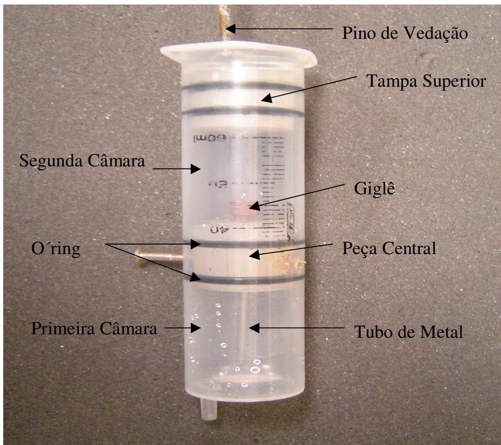
**Figura IV.2: Foto da Seringa adaptada. Observa-se a tampa superior contendo dois *o-rings* (com o pino de vedação em posição) e o componente central (contendo o *giglê*), com dois *o-ring* que divide a seringa em duas câmaras de ar (inferior e superior).**
