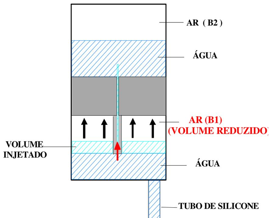
**Figura III.13: Ilustração da Câmara no momento em que o volume de líquido injetado (cor azul clara) comprime o volume de ar B1 no primeiro compartimento. As setas em cor preta indicam a bolha de ar B1 sendo comprimida, elevando a pressão. A seta de cor vermelha demonstra que, mesmo durante a injeção, há perda de volume, através do orifício, do primeiro para o segundo compartimento.**
