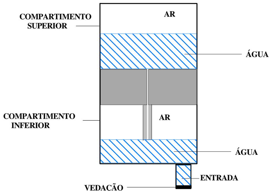
**Figura III.11: Compartimentos preenchidos parcialmente com um volume de água. A introdução deste líquido se dá pela entrada elaborada, e o líquido passa para ao segundo compartimento pelo orifício. A entrada permanece fechada após o preenchimento de água.**
