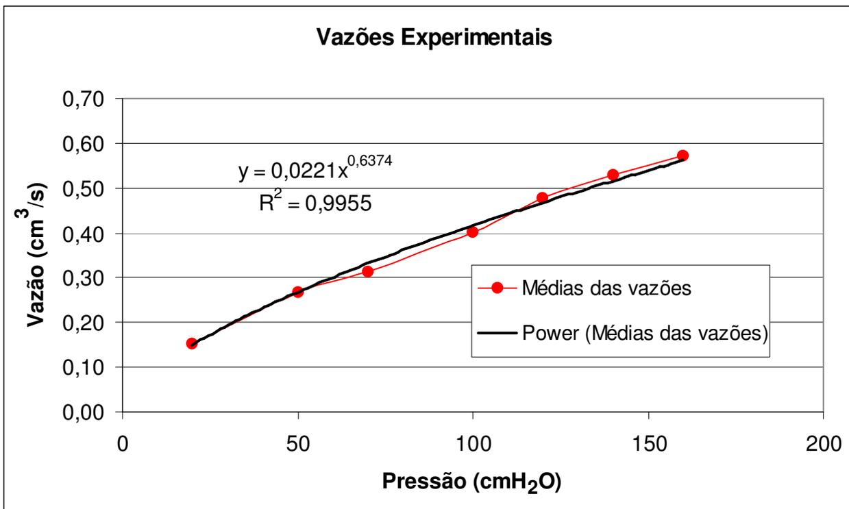
**Figura V.9:** Gráfico da Pressão (cmH<sub>2</sub>O) *versus* Vazão (cm<sup>3</sup>/s) experimental contendo a curva de Potência como regressão, juntamente com a equação correspondente e o valor de R<sup>2</sup>.
