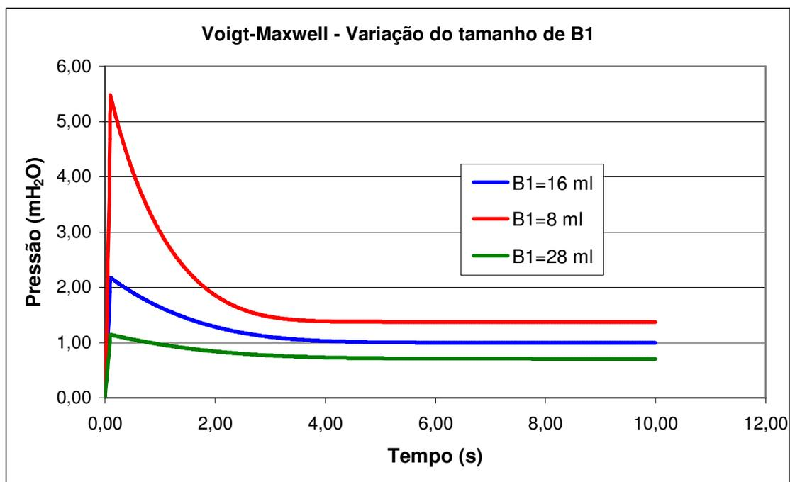
Figura III.30: Exemplo do modelo de Voigt-Maxwell variando-se o volume de ar em B1 ( $V_{b1}$ ).
