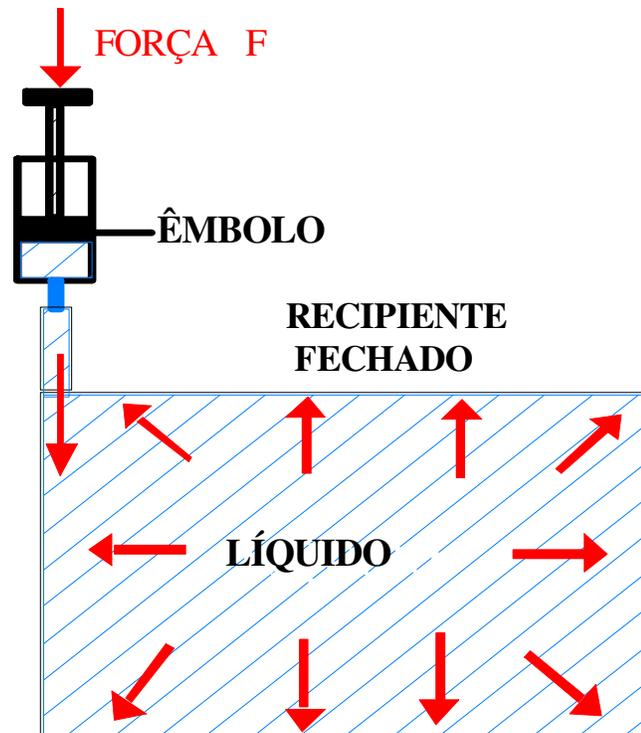
**Figura III.5: Recipiente completamente preenchido com líquido (água) conectado a uma seringa comum. Ao aplicar-se uma força  $F$  no êmbolo da seringa, há um aumento da pressão em um ponto do líquido que é transmitido integralmente para todos os pontos do líquido.**
