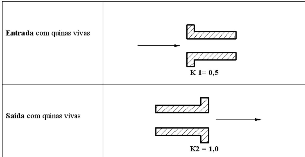
**Figura III.24:** Valores dos coeficientes de perdas específicas em relação ao tipo de entrada e/ ou saída de um acessório (FOX, 1998). No caso do gíglê em questão, o  $K$  possui o valor de 0,5 na entrada do orifício e 1,0 na saída.
