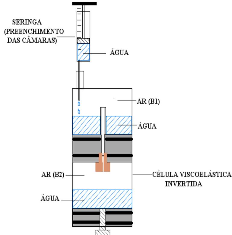
**Figura IV.13: Seringa comum utilizada para preenchimento das câmaras de ar da Célula Viscoelástica. O desenho ilustra a Célula invertida, com a primeira câmara inicialmente vazia, sendo preenchida de líquido para formar a bolha de ar. O mesmo procedimento é utilizado para a segunda câmara, onde o pino de vedação é retirado da tampa superior e a câmara é preenchida, formando a segunda bolha.**
