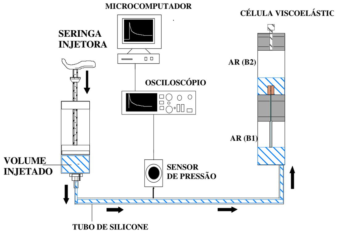
**Figura IV.6: Arranjo experimental: Circuito hidráulico composto por tubo de silicone preenchido com água destilada. Conectados a este, encontram-se a Célula Viscoelástica em uma extremidade e a seringa injetora na outra. O sinal proveniente do sensor de pressão é digitalizado pelo osciloscópio e transferido ao microcomputador PC, via interface USB.**
