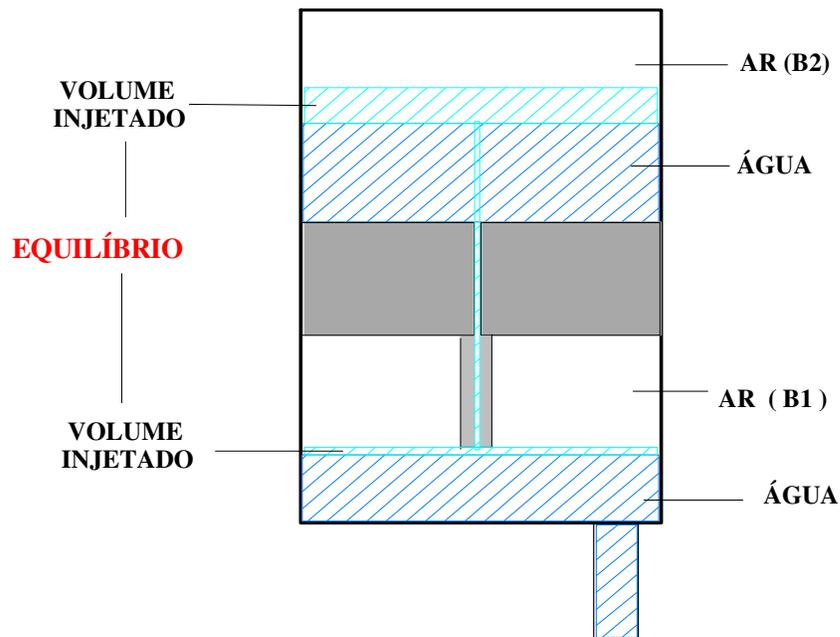
**Figura III.17: Câmara em seu estado de equilíbrio, contendo o volume total de líquido injetado no sistema, representado pela cor azul clara. Parte deste volume permanece em B1 e a outra em B2, convergindo a pressão do sistema para um patamar pressórico acima do inicial (B1 e B2 reduzidos).**
