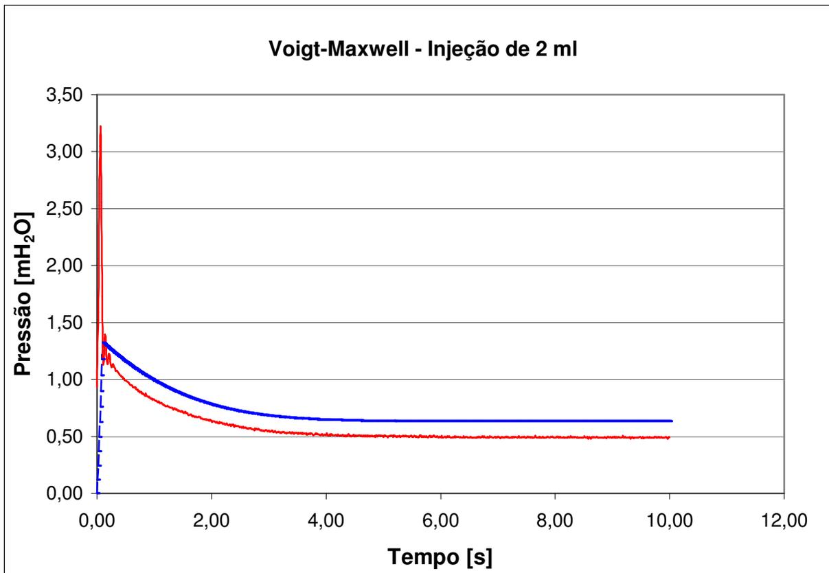
**Figura V.8: Voigt-Maxwell: Sinal experimental relativo à injeção de 2 ml (em cor vermelha) juntamente com o sinal teórico (em cor azul clara e mais espesso).**
