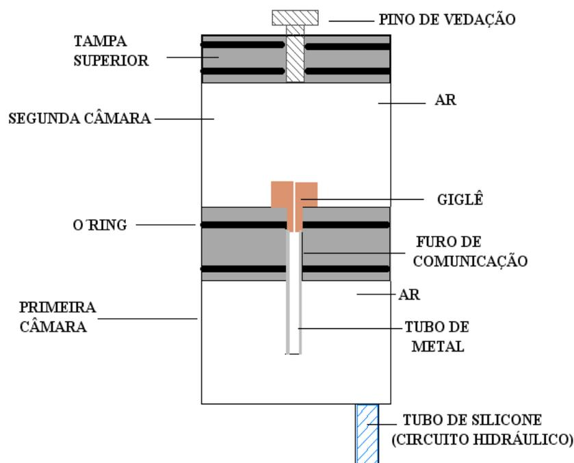
**Figura IV.1: Célula viscoelástica, adaptada a partir de uma seringa. Tampa superior contendo os *o´ring* e o pino de vedação, peça central (de nylon com *o´ring*) com o furo de comunicação por entre os compartimentos de ar (inferior e superior) e a junção com o tubo de silicone (circuito hidráulico).**
