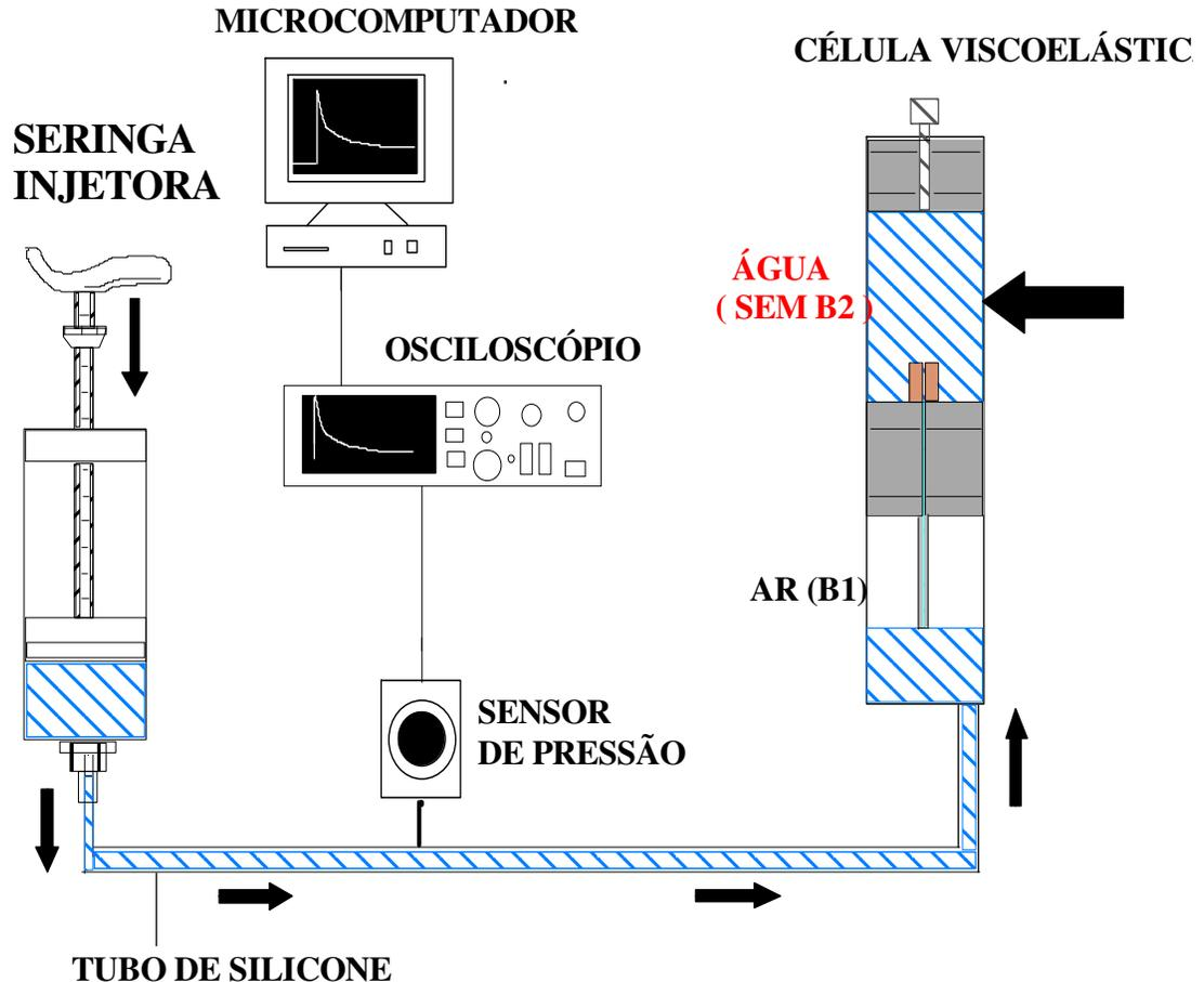
**Figura IV.20:** Montagem experimental do circuito hidráulico, contendo a Seringa injetora, o sensor de pressão, e a célula Viscoelástica com a segunda câmara completamente preenchida com água, isto é, sem efeito de B2 (indicado pela seta horizontal superior à direita).
