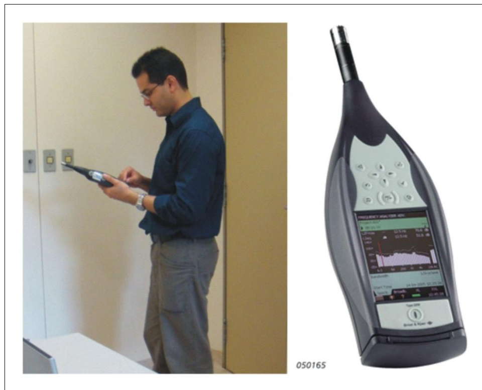
Figura 6 - Controle do nível de ruído ambiente com analisador de ruído, filtro de terço de oitava e um microfone capacitivo de 1/2”
