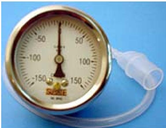
Figura 10 – Foto de um Manovacuômetro Tipo Analógico Com Variação de Pressão de -150 à +150 cm/H<sub>2</sub>O .
