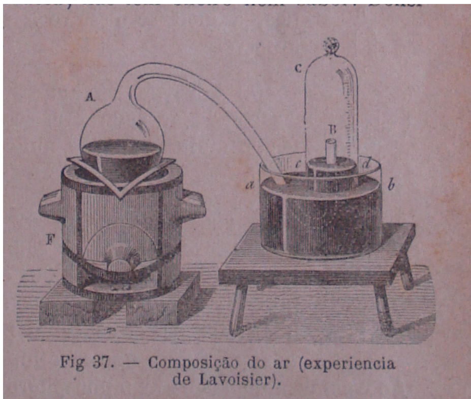
Figura 23: aparato utilizado na experiência de Lavoisier sobre a composição do ar
