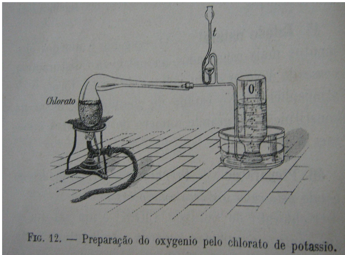
Figura 9: aparelhagem usada para preparação do oxigênio pelo clorato de potássio:
