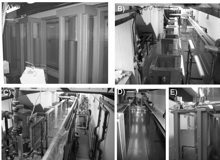
Figura 5.2 Tanque bidimensional fixo de fundo ajustável do SEFDL: a) Vista lateral; b-c) Detalhe do compartimento para instrumentos; d) Detalhe do fundo falso e; e) Vista frontal com o tubo de alimentação de água.
