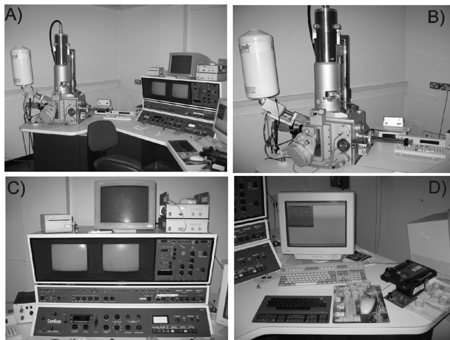
Figura 5.7 Microscópio eletrônico de varredura – MEV: a) Vista geral; b) Vista da célula; c) Console de processamento e; d) Console de saída das imagens.
