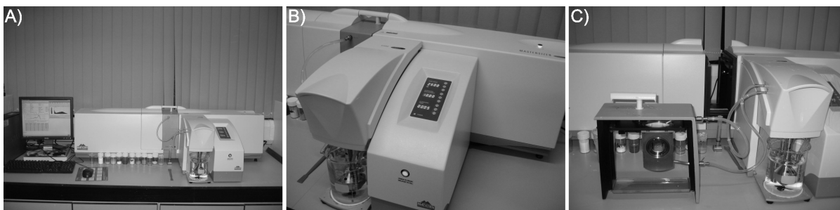
Figura 5.10 Analisador de partículas a laser - Malvern Mastersizer 2000: a) Vista geral. b) Detalhe do sistema de colocação dos grãos e; c) Detalhes da célula de medida.
