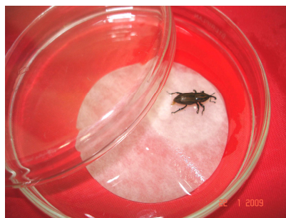
FIGURA 5. Armadilha de “White” constituída de placa de petri com uma lâmina de água e disco de papel filtro umedecido.
