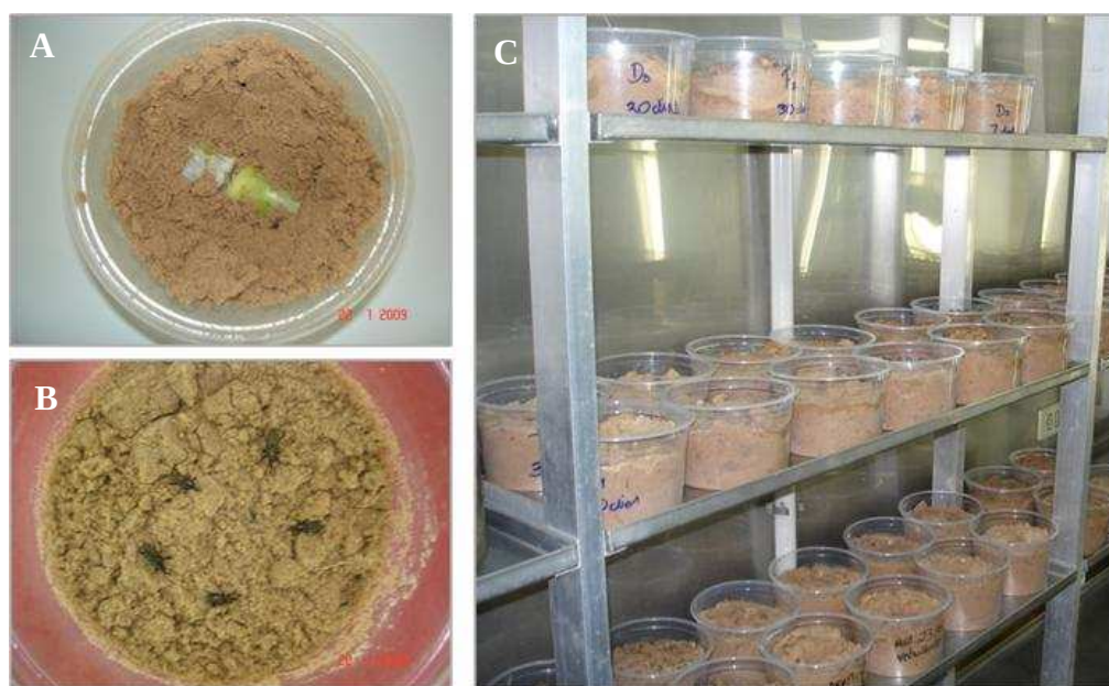
FIGURA 4. Potes plásticos contendo solo arenoso e colmo de cana-de-açúcar (A) utilizados para realização do ensaio em laboratório (B), mantidos em sala climatizada (C).
