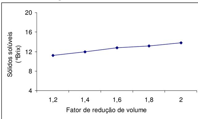
**Figura 12** - Sólidos solúveis (°Brix) no retentado do suco de maçã durante a nanofiltração, em função do fator de redução de volume – temperatura de 30°C, pressão de 9 bar e velocidade tangencial de 1,4m/s.
