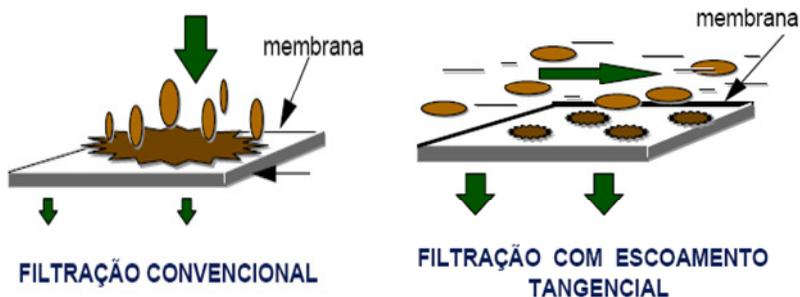
**Figura 1** - Filtração convencional x filtração tangencial
