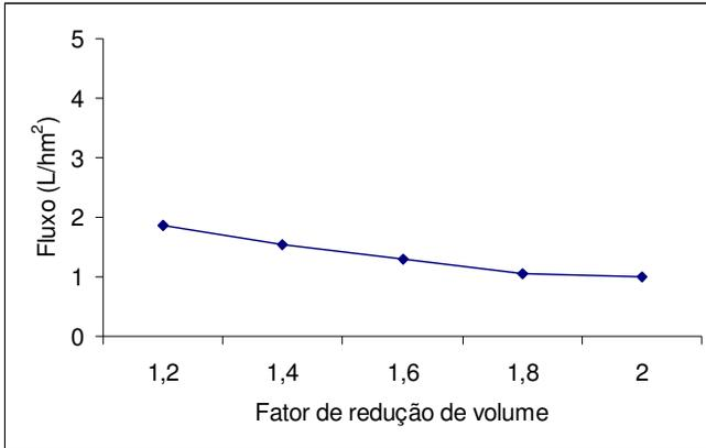
**Figura 11** - Comportamento do fluxo permeado do suco de maçã durante a nanofiltração, em função do fator de redução do volume (FRV) no tanque de alimentação – temperatura de 30°C, pressão transmembrana de 9 bar e velocidade tangencial de 1,4m/s.
