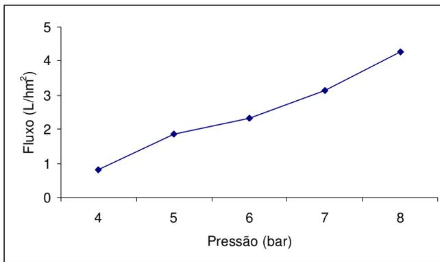
**Figura 5** - Comportamento do fluxo permeado do suco de maçã em função da pressão transmembrana – temperatura de 44°C e velocidade tangencial de 1,4m/s.
