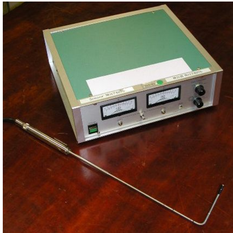
FIGURA 7.13 – MEDIDOR ELETROMAGNÉTICO DE VELOCIDADES
