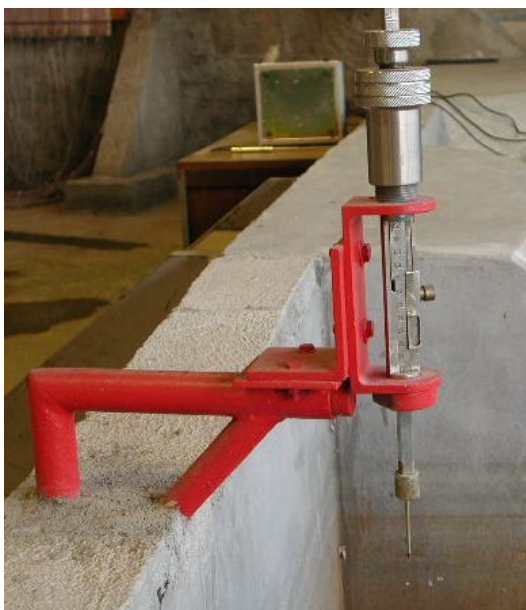
FIGURA 7.10 – RÉGUA LINIMÉTRICA PARA MEDIÇÃO DE NÍVEIS DE ÁGUA NO MODELO
