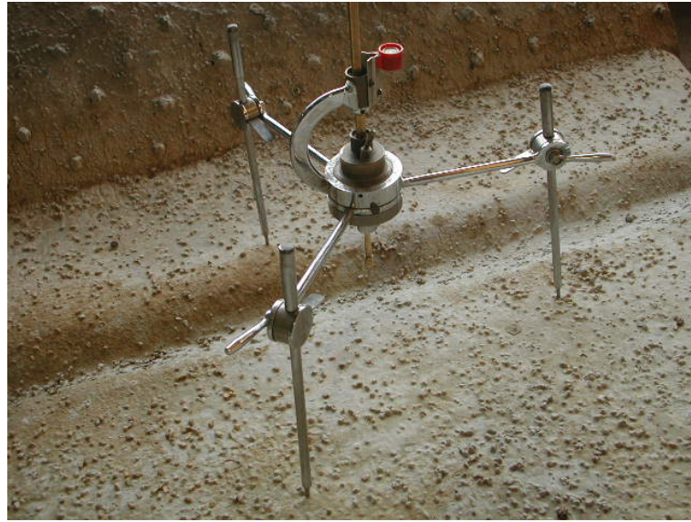
FIGURA 7.12 – ARANHA – DISPOSITIVO MÓVEL PARA MEDIÇÃO DE NÍVEIS DE ÁGUA
