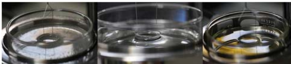
Figura 22. Inserção do anel na solução para medir a tensão superficial em função da concentração do surfactante.
