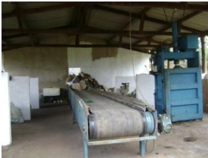
Figura 74 – Espaço físico do barracão de triagem de recicláveis mostrando esteira, prensa vertical e baias de separação.
