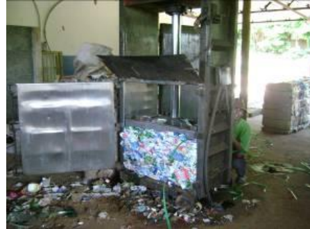
Figura 42 – Prensa hidráulica vertical (máquina enfardadeira) da COOTRAMAT.
