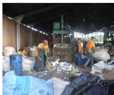
Figura 121 – Visão geral do galpão de triagem, mostrando prensa vertical, empilhadeira (ao fundo) e funcionários uniformizados com EPIs.
