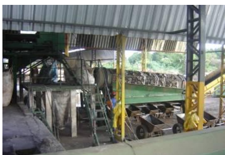
Figura 128 – Vista geral da peneira para os resíduos orgânicos que serão transformados em composto orgânico.
