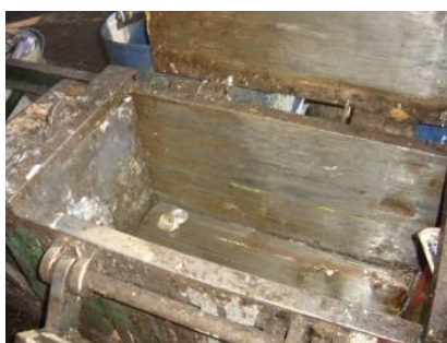
Figura 122 – Prensa horizontal utilizada para enfardar metais.
