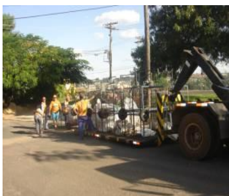
Figura 124 – Caminhões do tipo roll-on coletando caçambas de materiais recicláveis móveis.
