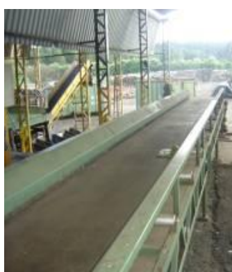
Figura 120 – Esteira de triagem de materiais recicláveis do programa de coleta seletiva.
