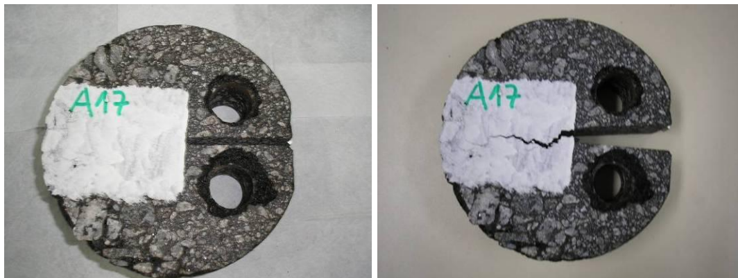
Figura 4.18: Exemplo de corpo-de-prova pintado antes e após a realização do ensaio.
