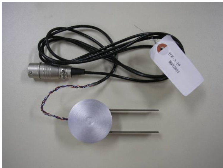
Figura 4.10: Clip-on-gage utilizado para a realização dos ensaios de fratura no Laboratório de Estruturas da COPPE/UFRJ.
