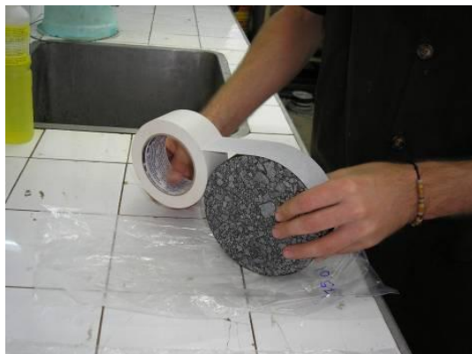
(a) corpo-de-prova sendo envolvido com fita adesiva
