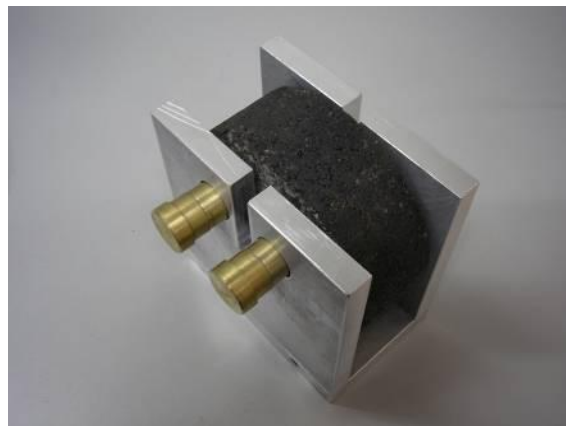
(b) pinos e corpo-de-prova em posição
