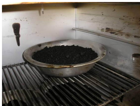
(b) Mistura asfáltica em condicionamento
