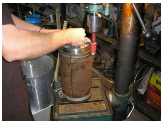
(c) colocação do gabarito de realização dos furos
