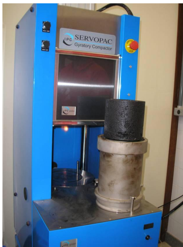
Figura 3.8: Compactador giratório utilizado na moldagem dos corpos-de-prova no Laboratório de Pavimentação da COPPE/UFRJ.
