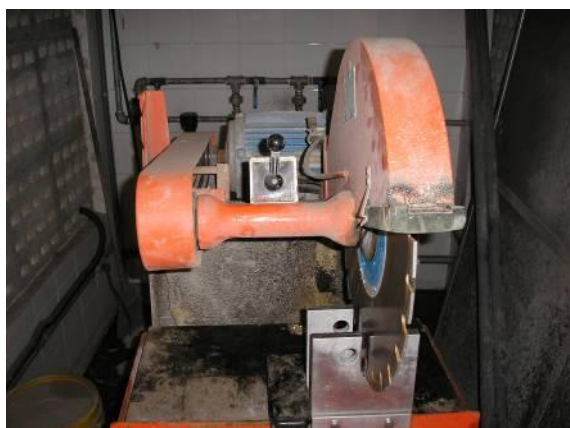
(c) fixação e ajuste do gabarito ao carrinho da serra
