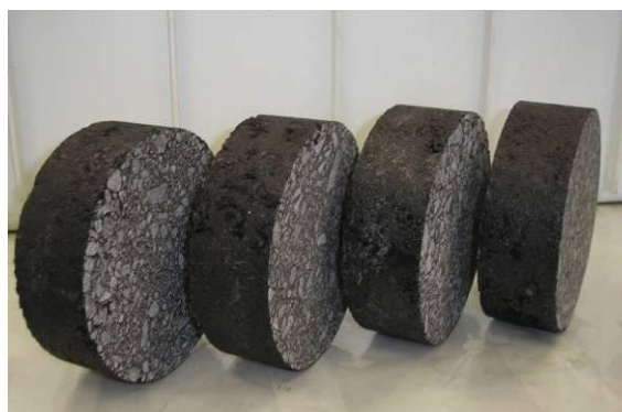
(b) Corpos-de-prova faceados
