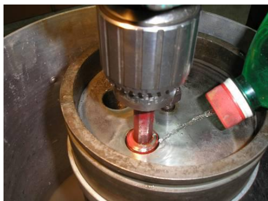
(e) injeção de água durante a realização dos furos
