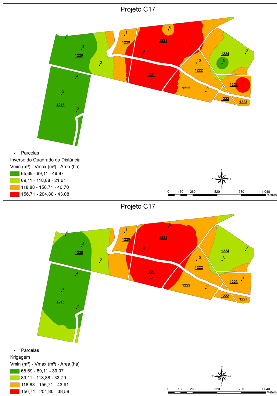
FIGURA 14 Estratificação obtida por meio do interpolador IQD e da Krigagem para o projeto C17.
