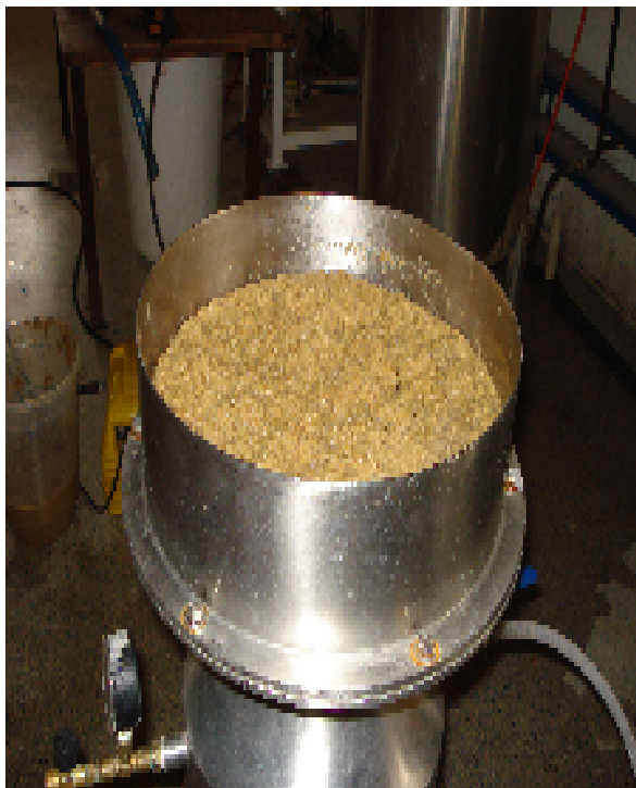
Figura 8 – Filtro a vácuo utilizado para separar o extrato líquido das fibras após o processo de hidrólise dos rizomas de gengibre.
