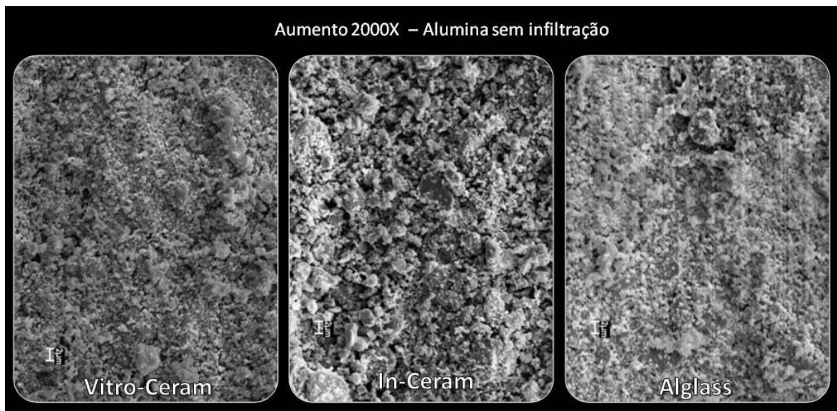
Figura 22 – Fotomicrografia da alumina sinterizada sem a infiltração por vidro com aumento de 2000X.
