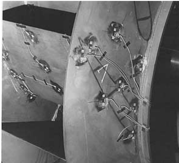
Figura 1.2 - Strain gage instalado em turbina.
