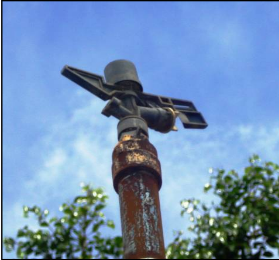
Figura 17 - Irrigação do tipo aspersão utilizada na fase 1
