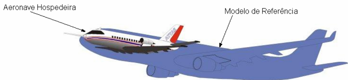
Figura 1-3 - Princípio dos simuladores em vôo
