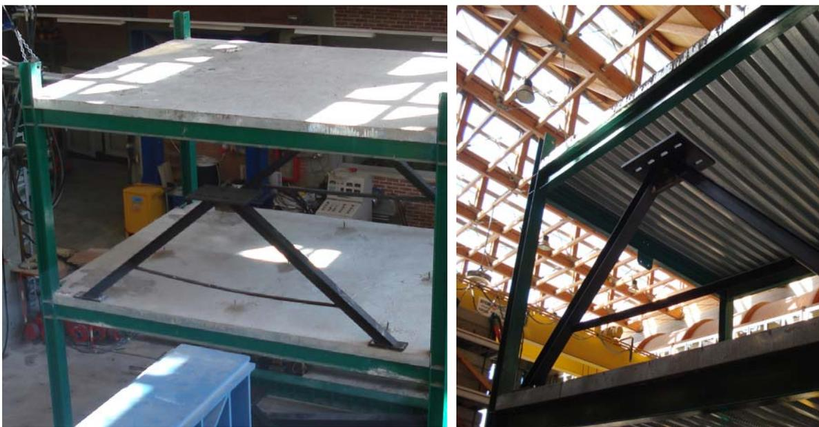
Figura 8.2 – Modelo experimental do pórtico: Lajes.
