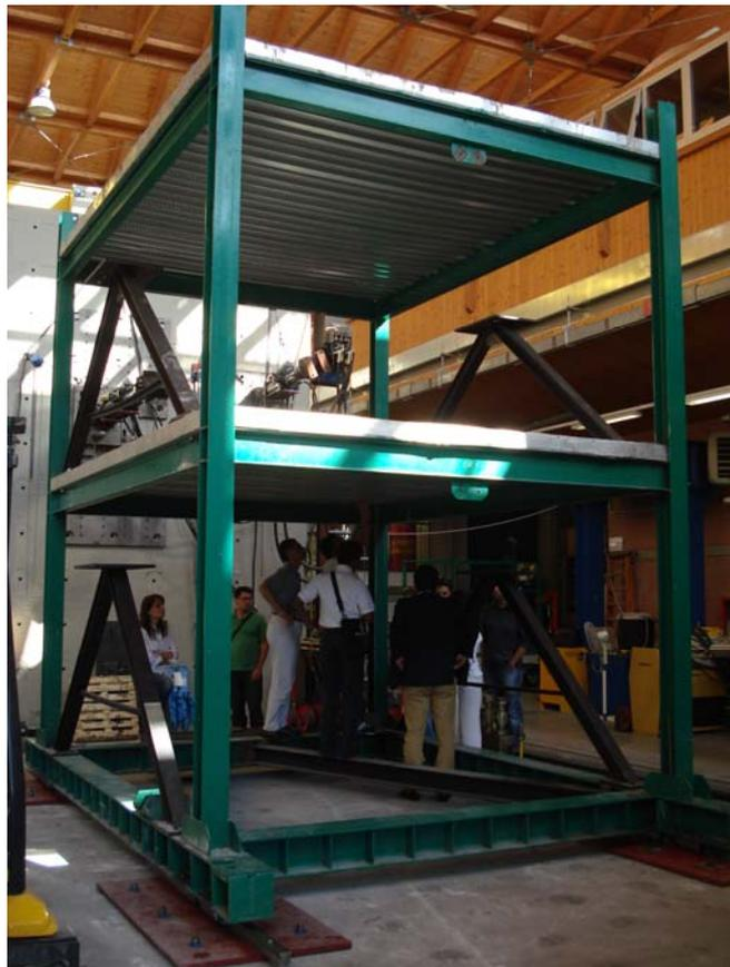
Figura 8.1 – Modelo experimental do pórtico.
