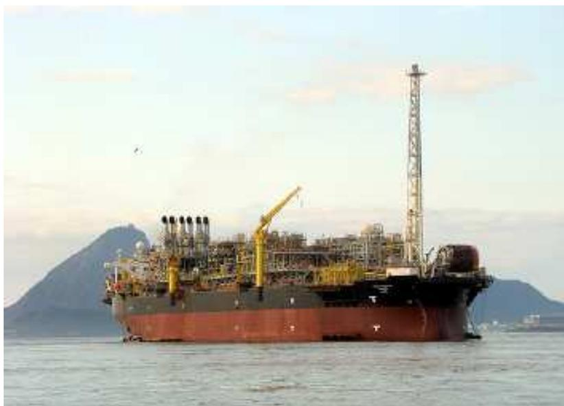
Figura 44 - Sistema Flutuante de Produção, Armazenamento e Alívio (FPSO).
