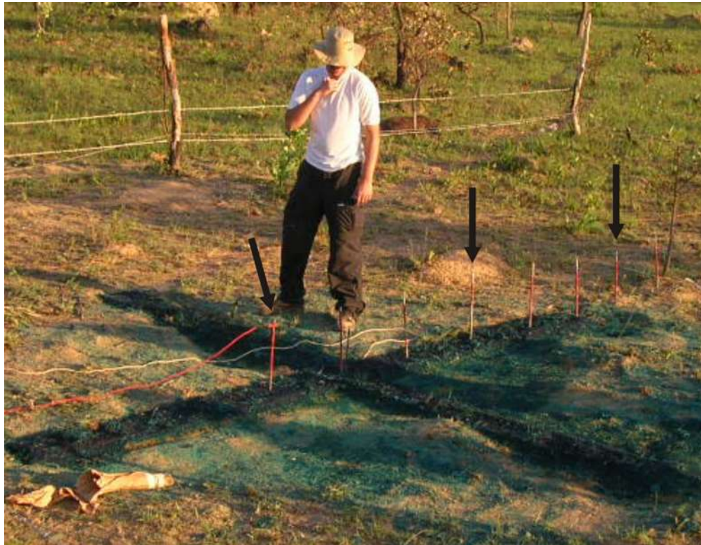
FOTO 4.6 - Medida de eletrorresistividade realizada após a injeção da solução traçadora, as setas indicam os eletrodos.
