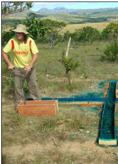
FOTO 4.11 - Perfuração do solo com trado próprio para instalação dos tensiômetros, bem próximo à cruz
