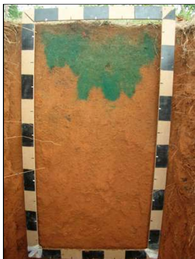
FOTO 4.14 - Trincheira menor aberta para observação do fluxo marcado pelo corante azul
