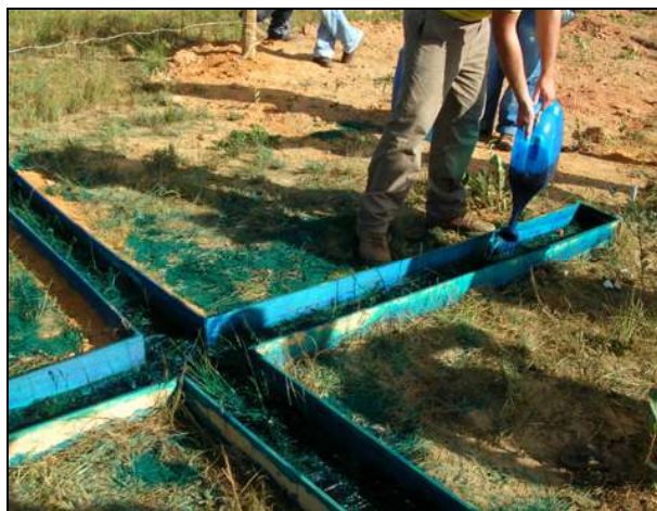
FOTO 4.4 - Irrigação da solução traçadora azul em uma estação em cruz
