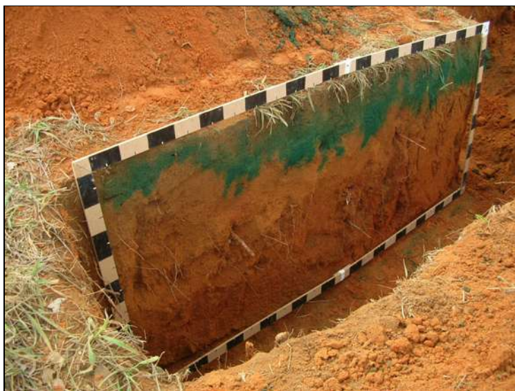
FOTO 4.15 - Trincheira maior aberta para observação do fluxo marcado pelo corante azul
