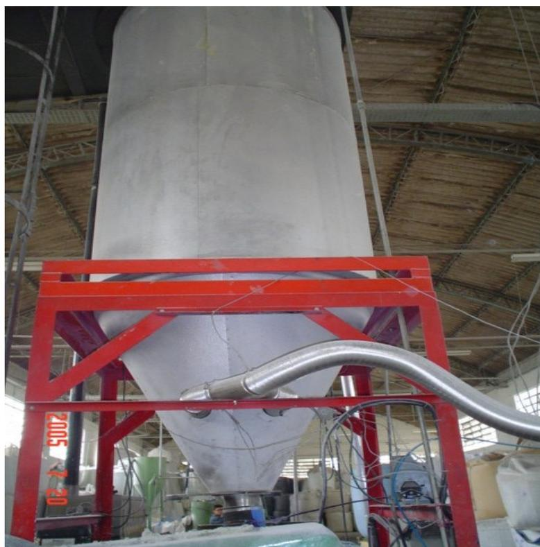
FIGURA 12 – Silo de secagem posicionado na alimentação da extrusora
