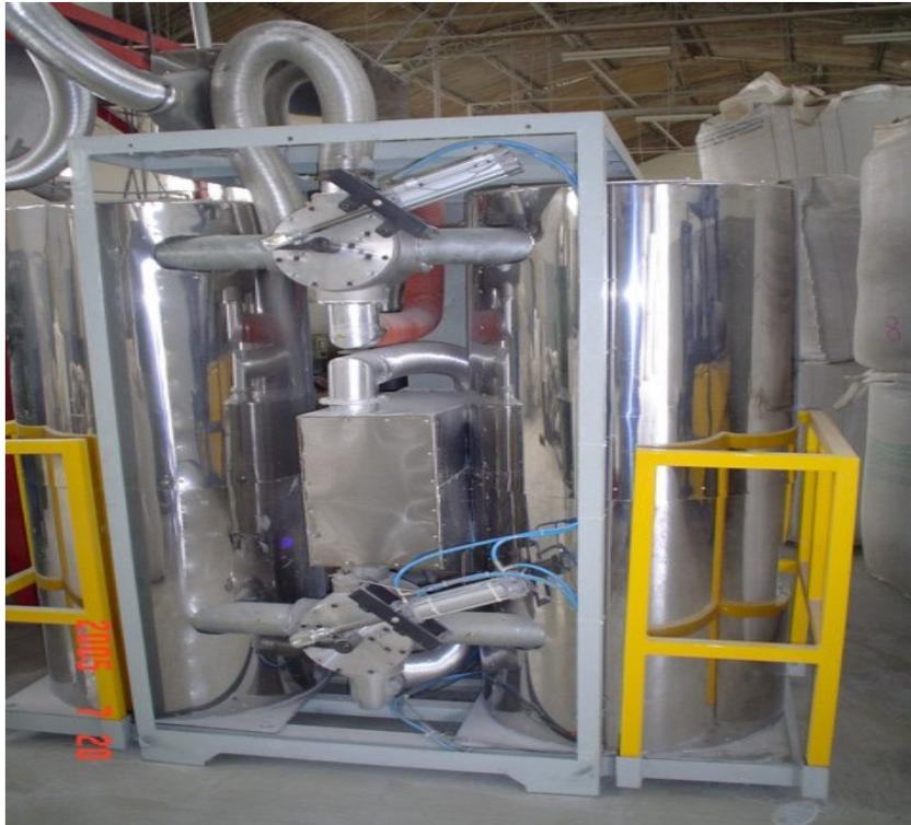
FIGURA 13 – Conjunto secador desumidificador para PET.
