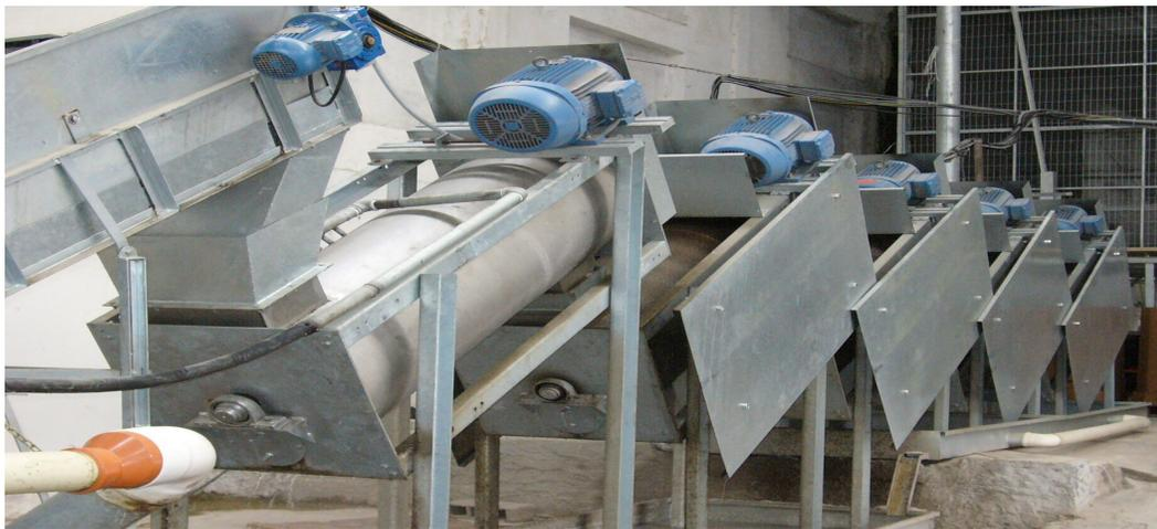
FIGURA 11 – Conjunto de lavadoras e secadoras
