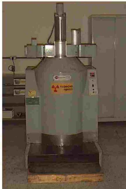
FIGURA 10 – Foto de um irradiador de  $^{60}\text{Co}$  tipo *Gammacell-220*
