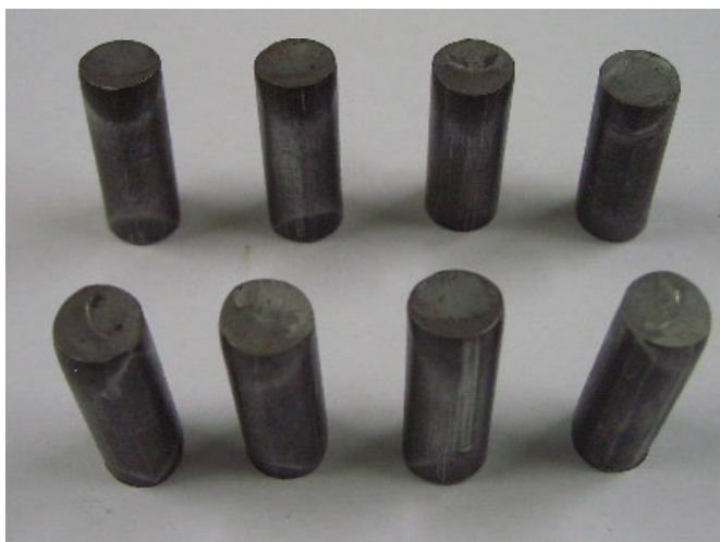
Figura 19: Blanche obtido através do procedimento de corte. Fonte: Fotografia de Erlano Campos dos Reis
