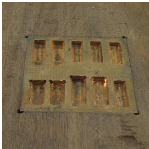
Figura 15: Dispositivo de cobre utilizado na marcação eletrolítica dos corpos-de-prova conformados Fonte: Fotografia de Erlano Campos dos Reis
