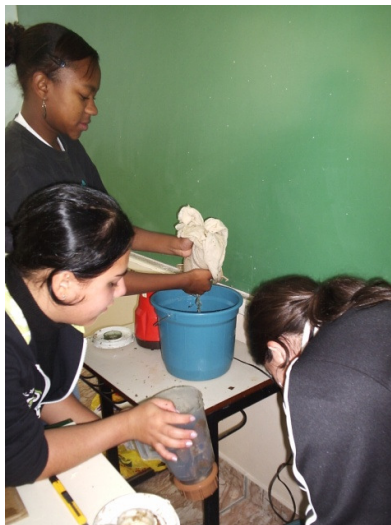
Figura 24 - Etapa de retirada do excesso de água do material triturado. (Fonte: Maria Bernadete S.S. Carvalho, 2007)
