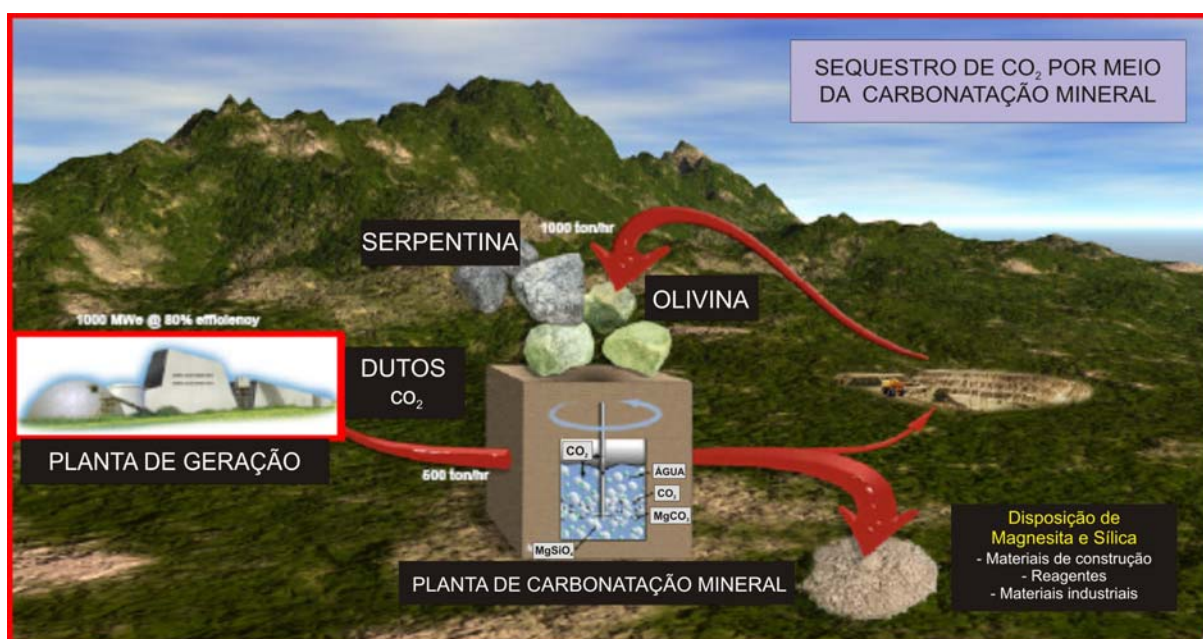
Figura 4 - Processo e fluxos de materiais relacionados com a carbonatação mineral ex-situ de rochas silicáticas ou resíduos industriais. Fonte: Golderg et al. , (2000)
