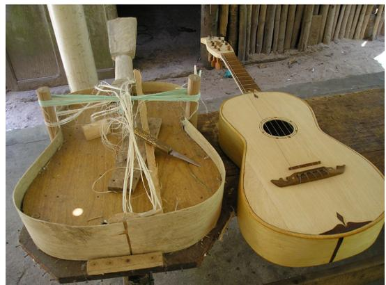
**Foto 6 – Viola branca já pronta (a mais recente construída por Sr. Valter) ao lado do violão que está no molde. Detalhe do canivete utilizado na construção dos instrumentos.**
