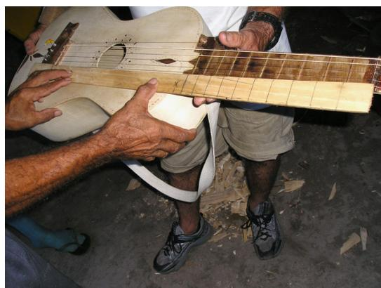
**Foto 16 - Molde da escala, no qual consta as marcações de onde devem ser posicionados a boca, o rastilho e o cavalete.**
