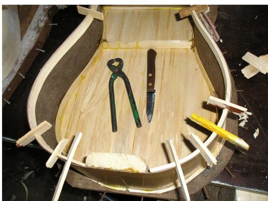
**Foto 14 - Algumas das ferramentas utilizadas pelo construtor e detalhe do contra-forte.**
