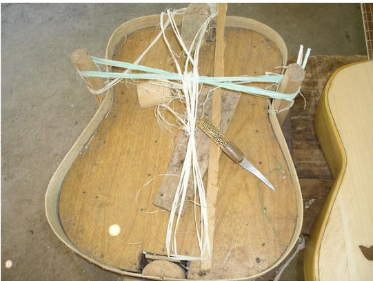
**Foto 8 - Violão na fôrma, que estava sendo construído por Ordilei na ocasião de minha visita. Como não havia nenhuma viola em construção, Sr. Valter exemplificou o processo de construção utilizando-se do violão que estava sendo construído por seu filho, já que o procedimento utilizado é praticamente o mesmo.**
