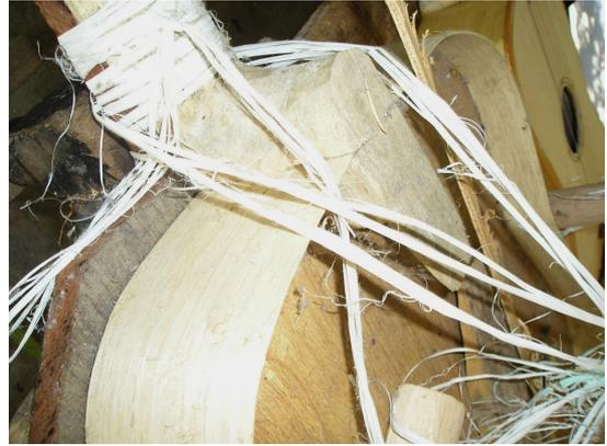
**Foto 9 - Detalhe da fixação do braço nas faixas laterais e a amarração do instrumento para fixar as partes, conforme relatado anteriormente por Sr. Florêncio.**
