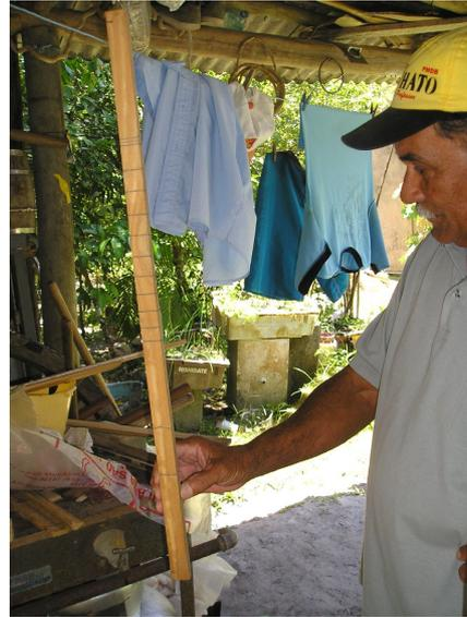
**Foto 10 - Molde utilizado para demarcar os pontos no braço da viola, ou seja, o molde da escala do instrumento.**
