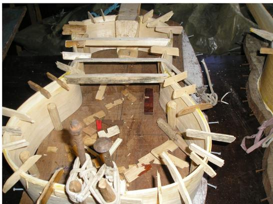
**Foto 12 - Aros de caxeta no molde. Detalhe das presilhas para ajudar na fixação dos sobre-aros.**
