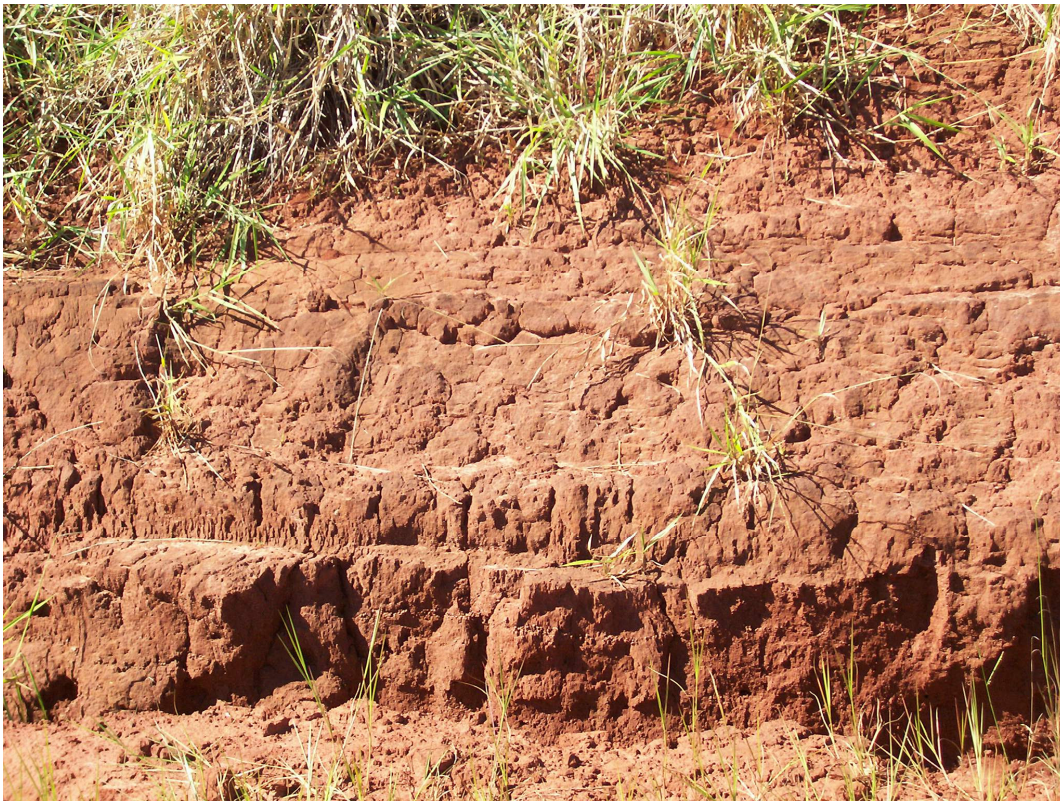
Foto 14. Ponto 9. Afloramento de solo de Formação Serra Geral, material decomposto, intemperizados. Camada sobrejacente à Formação Serra Geral.
