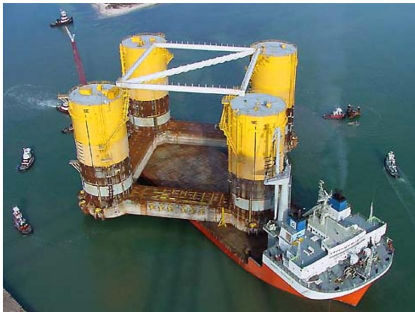
**Figura 3.4 Casco convencional. Reboque a seco do casco da TLP.**
