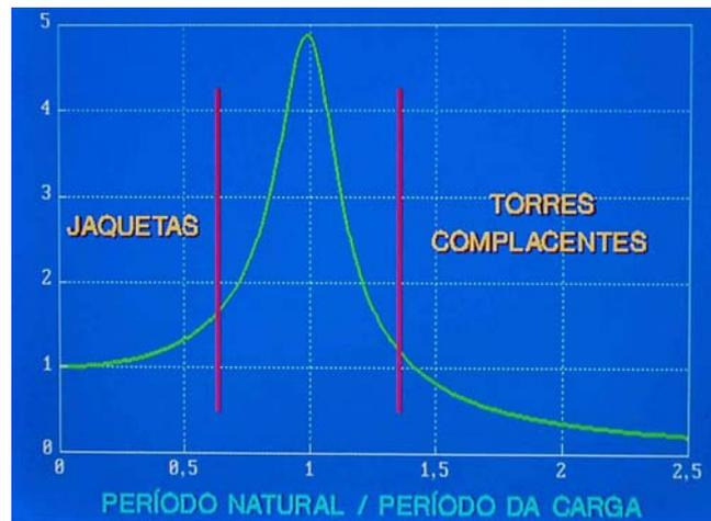
Figura 2.2 Comparação de comportamento dinâmico jaqueta x torre complacente
