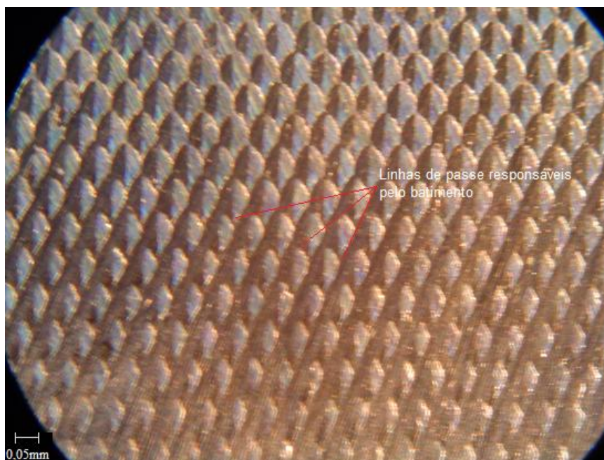
Figura 87: Fotografia com microscópio óptico da superfície usinada a 250m/min com avanço por dente de 0,05mm/rev e profundidade de corte de 1,25mm.
