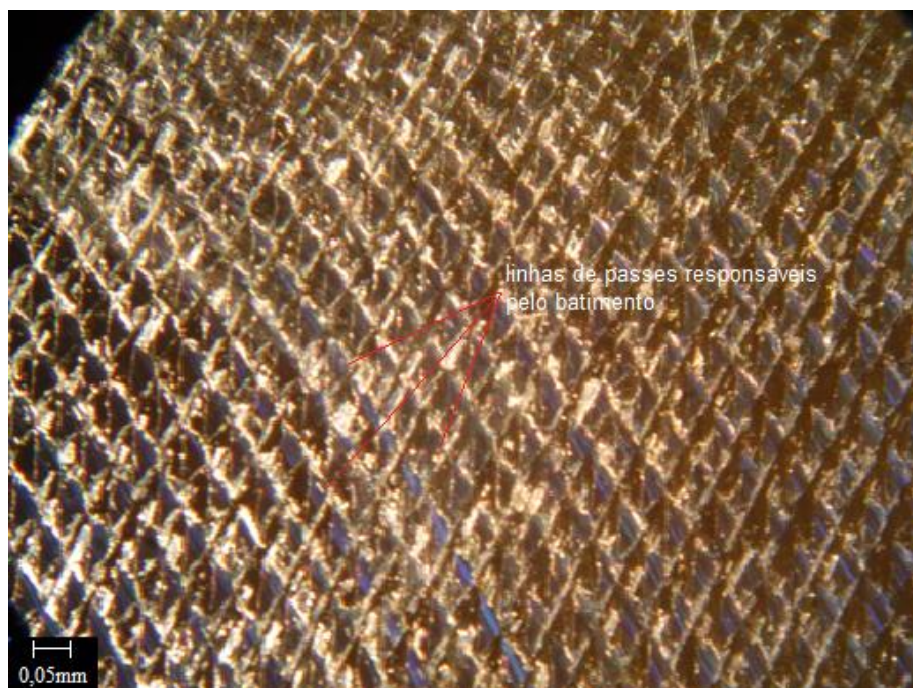
Figura 85: Fotografia com microscópio óptico da superfície usinada a 150m/min com avanço por dente de 0,05mm/rev e profundidade de corte de 1,25mm.
