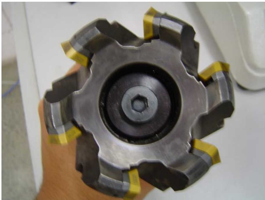
Figura 18: Fresa Sandvik com seis insertos utilizados nos testes.
